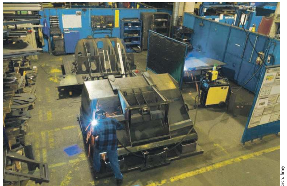
Jednym z najważniejszych elementów procesu produkcji jest spawanie konstrukcji ciężkich
