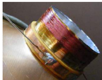
Rysunek 56. Cewka nawinięta na aluminiowym karkasie. Podejrzewam, że powoduje to problemy z indukowaniem się prądów wirowych.
