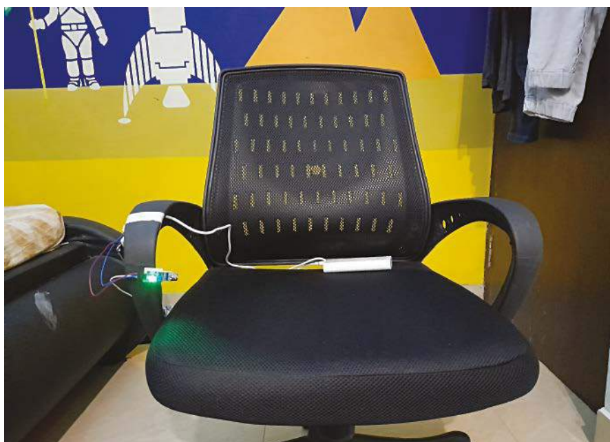
Rysunek 4. Opracowany przez autora nadajnik z czujnikiem podczerwieni zamocowany na krześle
