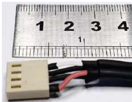
Fotografia 14. Każdy z czterech ekranowanych kabli stereo powinien wyglądać w ten sposób po zakończeniu montażu – podłączony do właściwie spolaryzowanych wtyczek i gotowy do połączenia z płytką zwrotnicy aktywnej
