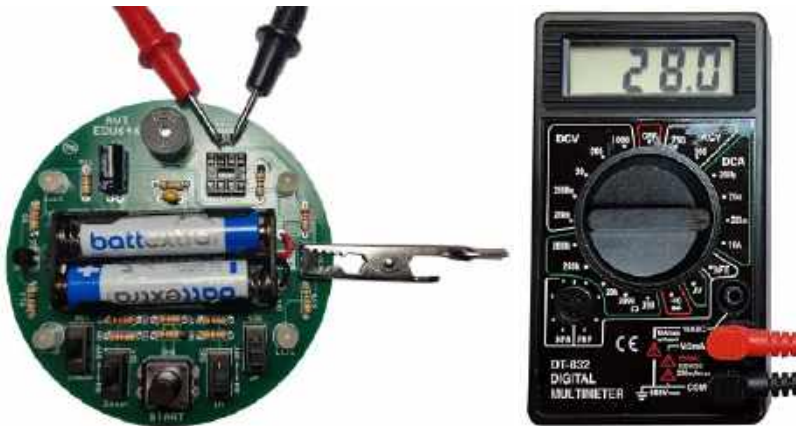
Fotografia 26. Pomiar prądu płynącego przez buzzer. Mikrokontroler został uprzednio wyciągnięty z podstawki, krokodylek zwiiera kolektor i emiter tranzystora T2, sondy miliamperomierza zostały przyłożone do pinów złącza zworki JP2
