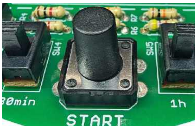
Fotografia 19. Poprawny montaż przycisku start. Wszystkie nóżki przycisku przeszły przez otwory na PCB, a podstawa przycisku przylega bezpośrednio do powierzchni PCB
