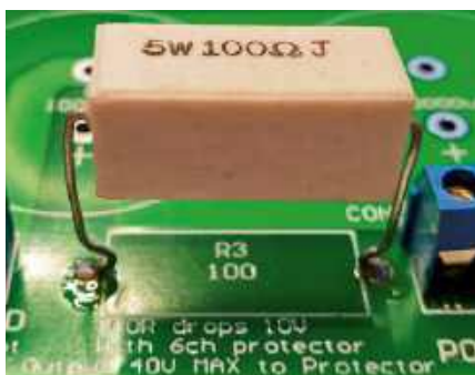
Fotografia 11. Aby ograniczyć nagrzewanie innych elementów, rezystory drutowe należy zamontować poza płytką drukowaną
