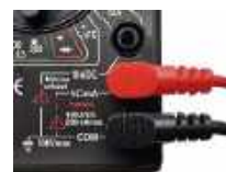
Fotografia 21. Poprawne podłączenie kabli na przykładzie multimetru DT-830B, ustawionego na funkcję woltomierza napięć stałych
