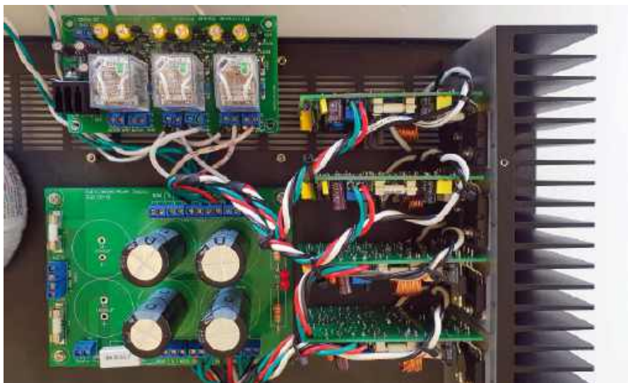
Fotografia 13. Podłączenie przewodów do modułu zabezpieczenia głośników najlepiej wykonać przed jego ostatecznym zamocowaniem w obudowie. Aby zyskać więcej miejsca podczas tej czynności, warto na czas montażu zdemontować tylny panel
