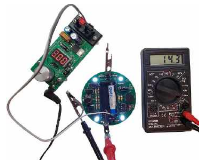
Fotografia 25. Pomiar prądu pobieranego przez 4 białe diody LED z rezystorami szeregowymi 100 Ω, zasilone napięciem 3 V. Z koszyeczka wyjęto przynajmniej jedną baterię, zdemonstrowano mikrokontroler a następnie kolektor i emiter tranzystora T1 zwarto za pomocą krokodyłka. Regulowany zasilacz ustawiony na napięcie 3 V w szeregu z multimetrem ustawionym na funkcję miliamperomierza w funkcji do 200 mA
