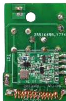
Rysunek 3. Schemat montażowy – widok z góry i z dołu rzeczywistej prototypowej płytki PCB, pilota bezpiecznego, zdalnie sterowanego wyłącznika sieciowego
