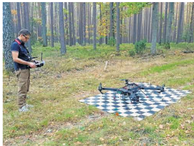
Przygotowania do startu drona ze skanerem laserowym
