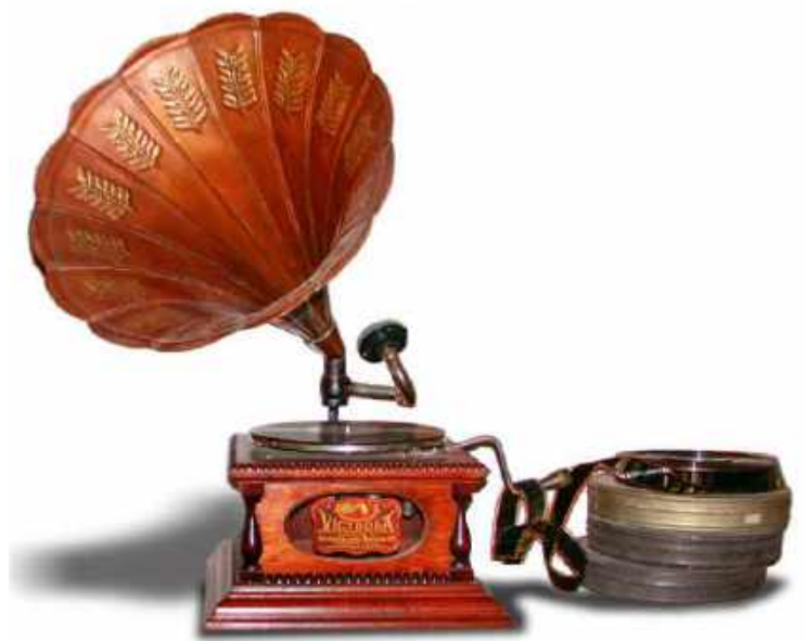
W 1925 roku firma „Victor Talking Machine Company” wyprodukowała gramofon o nazwie „Orthophonic Victrola”, wyposażony w tubę o kształcie wykładowym.
