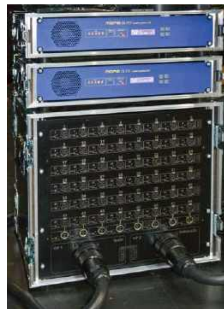
Konsoly współpracują z dwoma stageboxami DL151. Ośrodek dysponuje również analogowym 48-kanalowym splitterem firmy Klotz.
