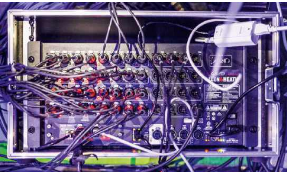
Pracuję jedynie na stageracku dLive CDM32, który jednocześnie jest tradycyjnym stageboxem i „głową” konsoly.
