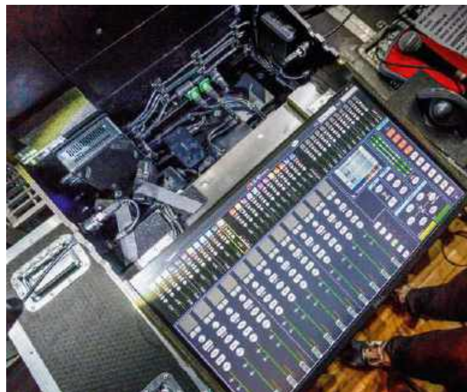
W środku zamknięty jest mały komputer Intel NUC w wersji z procesorem Intel i5 i 8 GB RAMu.
