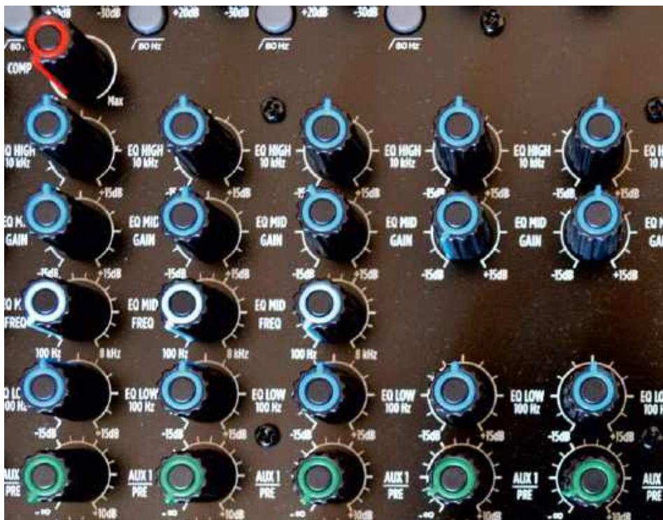
W kanałach stereo zamiast środkowego filtra z regulowaną częstotliwością mamy filtr o stałej częstotliwości 1,25 kHz.
