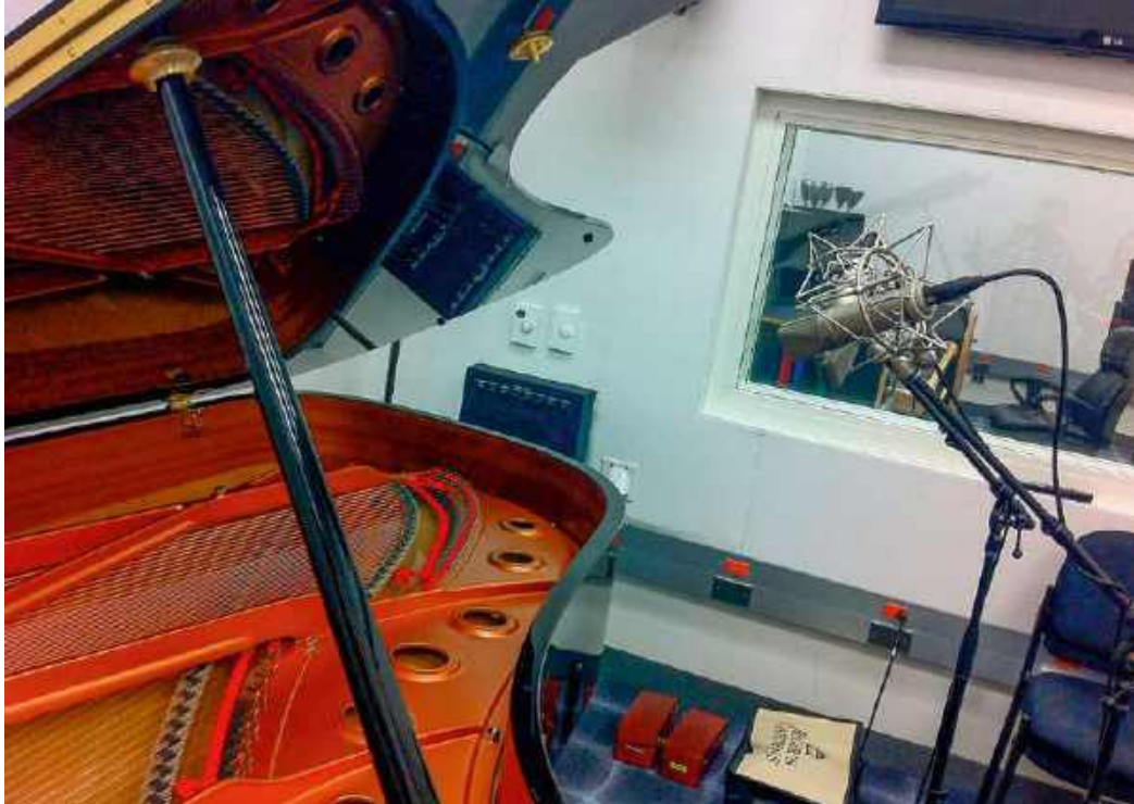
Technika X/Y zazwyczaj daje o wiele wyraźniejszy i bardziej precyzyjny obraz stereo, ale kosztem tego, co krytycy czasami określają jako „sterylny” dźwięk.
