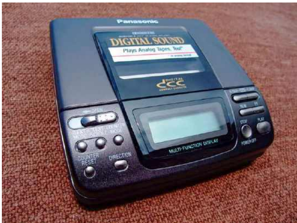
Urządzenia formatu DCC (Digital Compact Cassette) były mechanicznie prostsze od maszyn DAT, a tym samym również o wiele tańsze.
