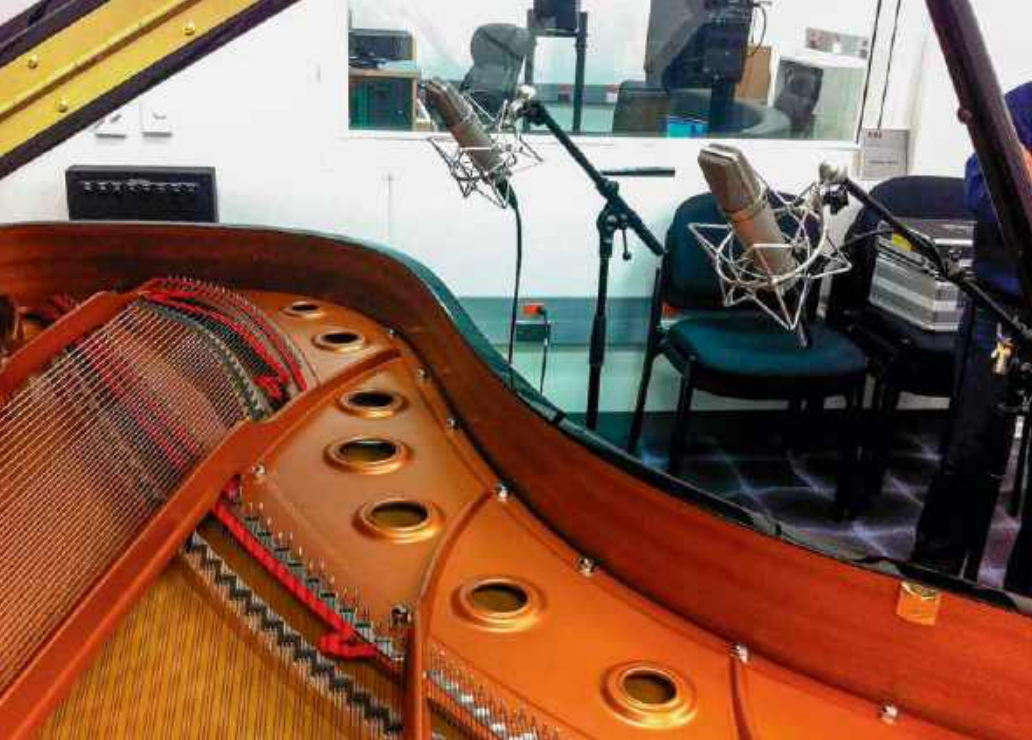
Wysokość usytuowania pary stereo jest przeważnie dość mała – 1,2 m do 1,5 m powyżej podłogi, na której stoi fortepian.
