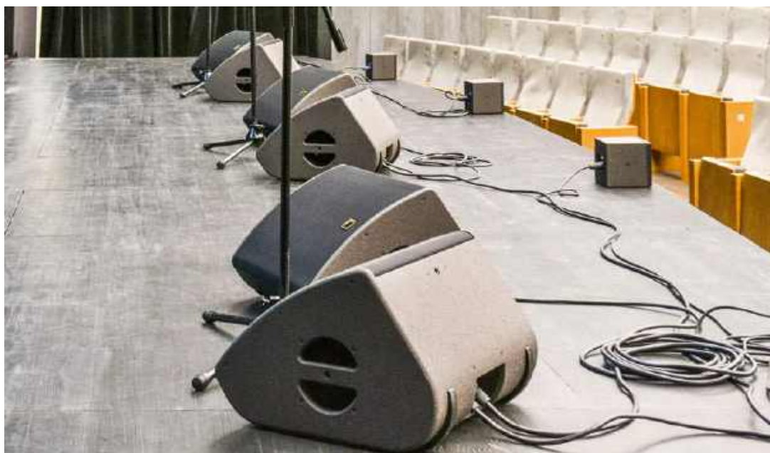
Nagłośnienie sceny, czyli monitory, to w sumie 8 zestawów L-Acoustics X12, zasilanych z 2 wzmacniaczy LA4X.
