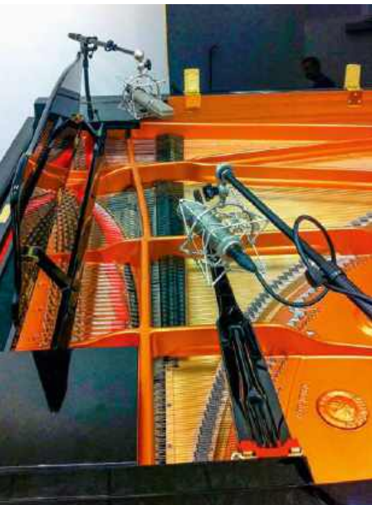
Przy bliskim omikrofonowaniu A-B istnieją dwie szkoły rozmieszczania mikrofonów – jedna sugeruje umieszczenie ich za lirą, nad młotkami.
