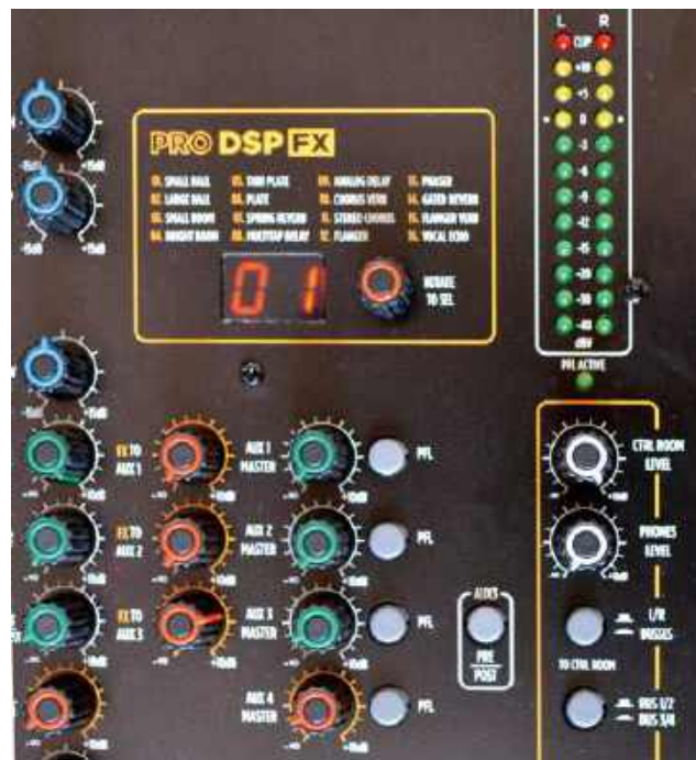
F 15XR ma na pokładzie procesor FX oferujący 16 predefiniowanych efektów.
