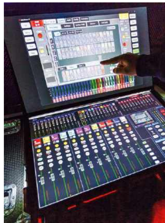
To, na czym rzeczywiście pracuję, to 2 ekrany dotykowe podłączone do komputera, który jedynie steruje systemem.
