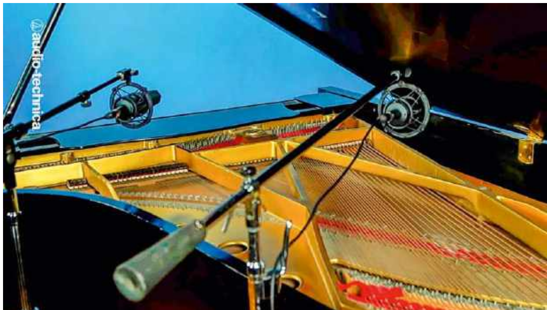
Drugim sposobem jest umieszczenie jednego mikrofonu w środku grupy strun dźwięków wysokich, za podstawką na nuty, a drugiego mikrofonu bliżej stopy fortepianu, w rejonie, gdzie struny dolnego i środkowego zakresu zachodzą na siebie.
