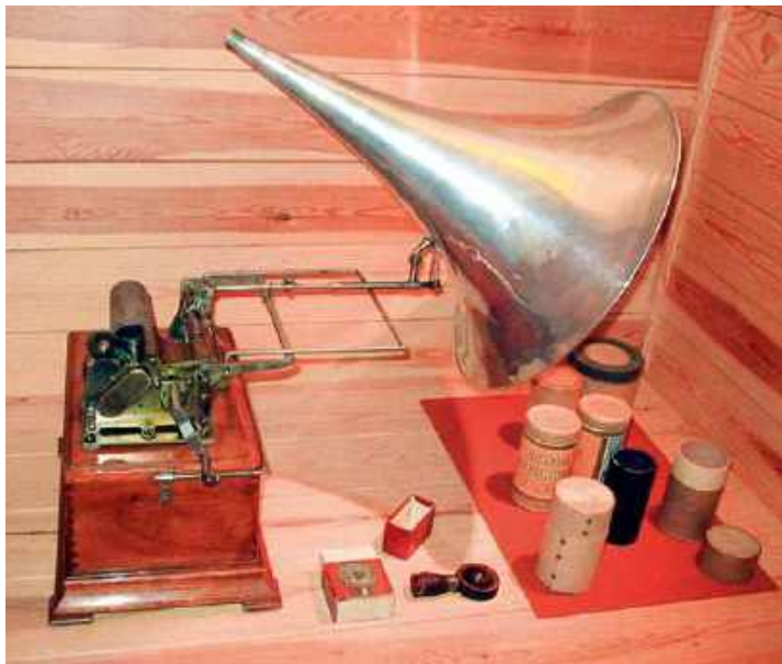
Fonograf wykorzystywał tak zwany wgłębny zapis na walcu pokrytym folią cynową.
