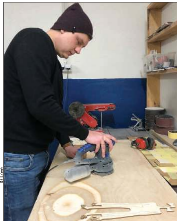
➤ W warsztacie prace są wycinane i szlifowane. Niekiedy niezbędne jest malowanie i lakierowanie
