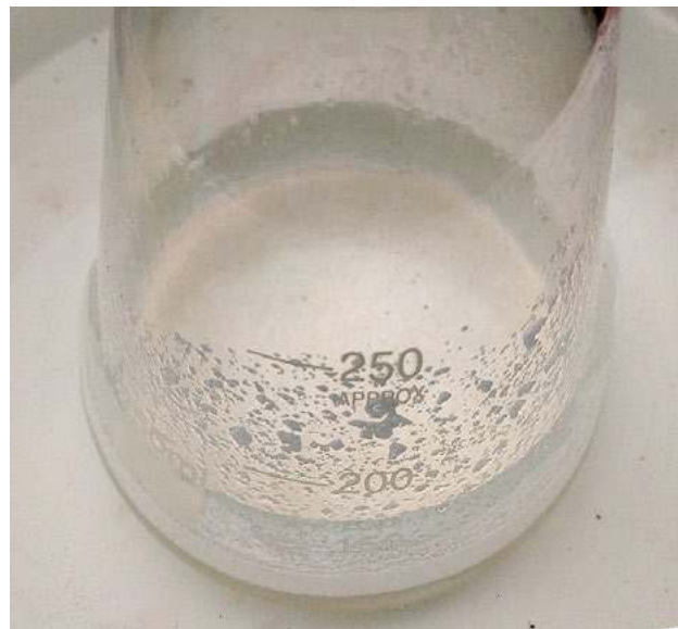
Fot. 8 – Mieszanina gotowa do reakcji nitrowania
