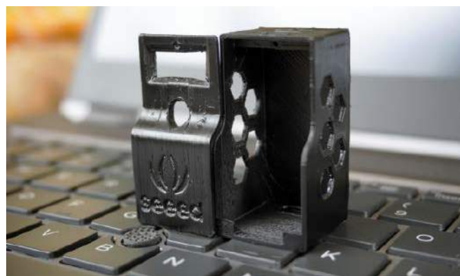
Fotografia 1. Obudowa z druku 3D dla sensora gestów
