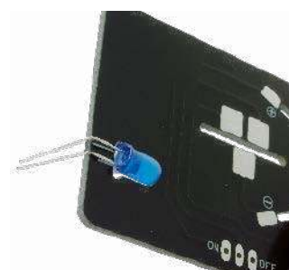
Fotografia 1. Sposób profilowania wyprowadzeń diod LED
