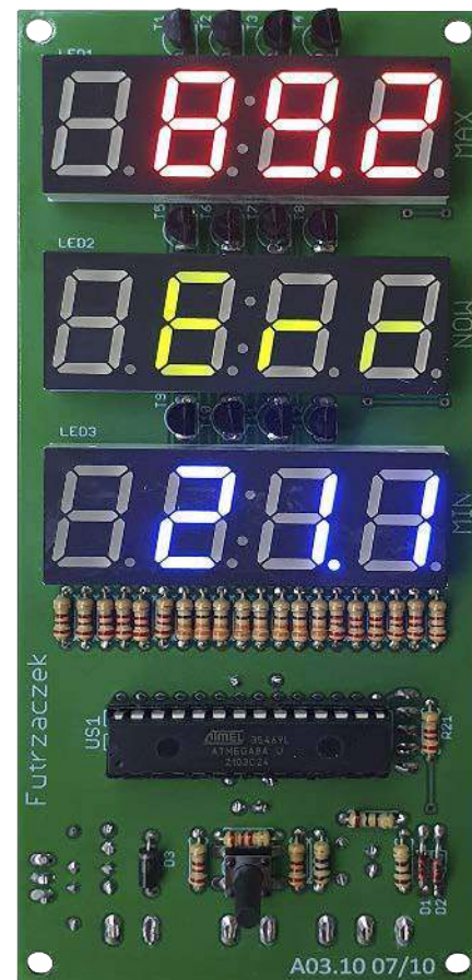
Fotografia 4. Wygląd wyświetlacza z komunikatem błędu czujnika
