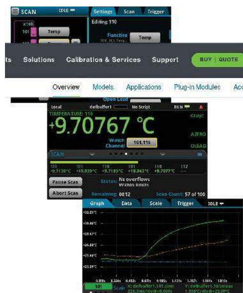
Rysunek 11. Przykładowe ekrany konfiguracji przyrządu i wizualizacji danych pomiarowych, wyświetlane przez urządzenie DAQ6510 ( https://t.ly/Pa5DS )
