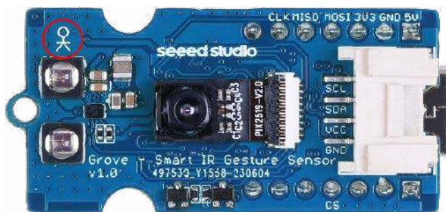
Rysunek 2. Oznaczenie orientacji na płycie sensora
