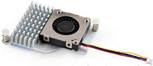
Fotografia 3. Aktywne chłodzenie Pi 5 (z materiałów fundacji)
