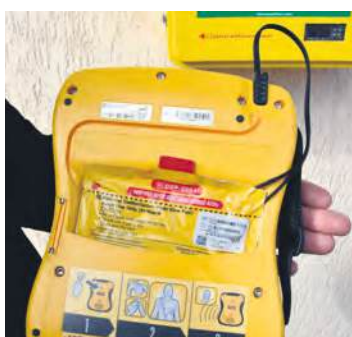
AED prowadzi ratownika (nawet osobę bez doświadczenia) krok po kroku, mówiąc co należy robić: np. „przyłóż elektrody”, „naciśnij przycisk wstrząsu”.
