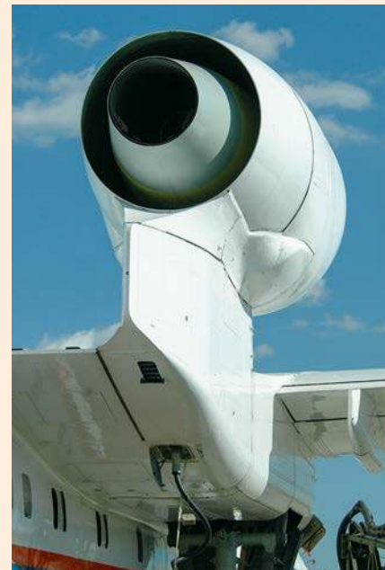
Silniki turbodrzutowe D-436TP zamontowano na pylonach nad skrzydłem, aby zapobiec dostawianiu się wody do wlotów powietrza podczas startu i lądowania.
