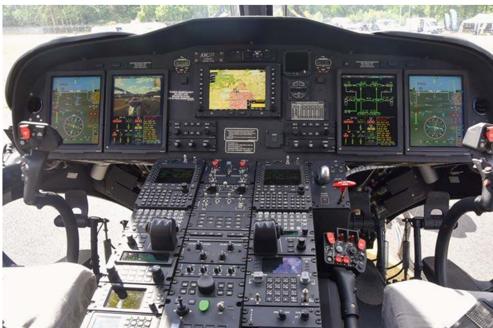
Kabina śmigłowca PH-139E z dużymi wyświetlaczami wielofunkcyjnymi.
