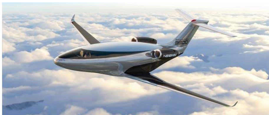
Kropłowy kształt kadłuba (o laminarnym profilu) Phantoma 3500 jest zoptymalizowany pod kątem redukcji oporu, co ma pozwolić na znaczne zmniejszenie zużycia paliwa oraz wydłużenie zasięgu, a także redukcję masy samolotu, co w sumie pozwoli zastosować silniki o mniejszym ciągu. Grafika: Otto Aerospace
