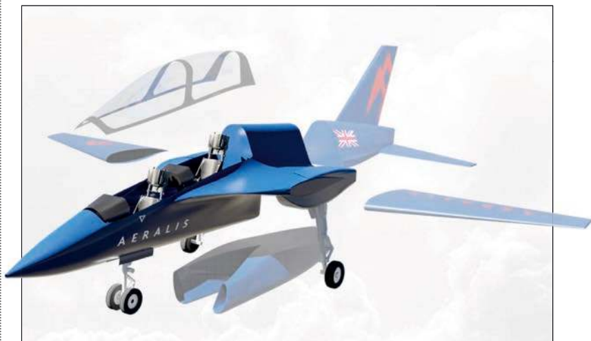
Konstrukcja projektowanego AJT opierała się na wspólnym kadłubie, do którego można było dostosowywać różne warianty zespołu napędowego i skrzydeł. Fot. Aeralis
