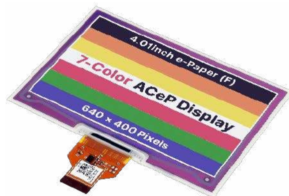
Fotografia 14. Wyświetlacz EPD ACeP ( http://t.ly/FmeQS )
