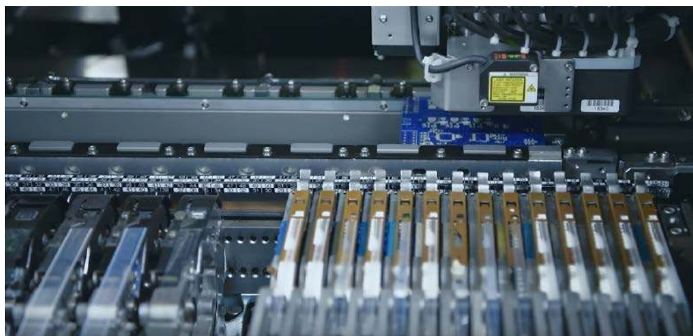
Fotografia 1. Automat pick & place w czasie montażu płytki drukowanej
