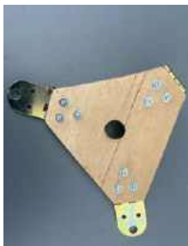
Płytkę statywu od góry po montażu
