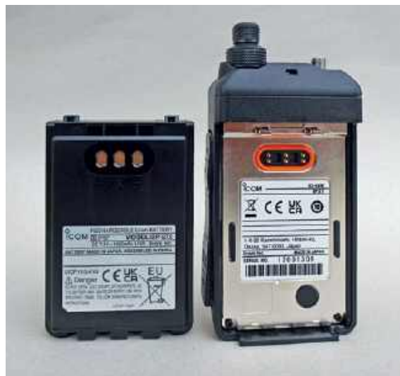
Akumulator BP-272 o pojemności 1880 mAh zapewnia długi czas pracy
