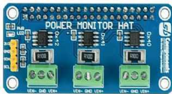
Rys. 5.. Moduł przetworników ADC produkcji SB Components
