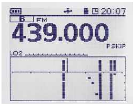
Wykres wodospadowy zapewnia szybką orientację w aktywności na paśmie
