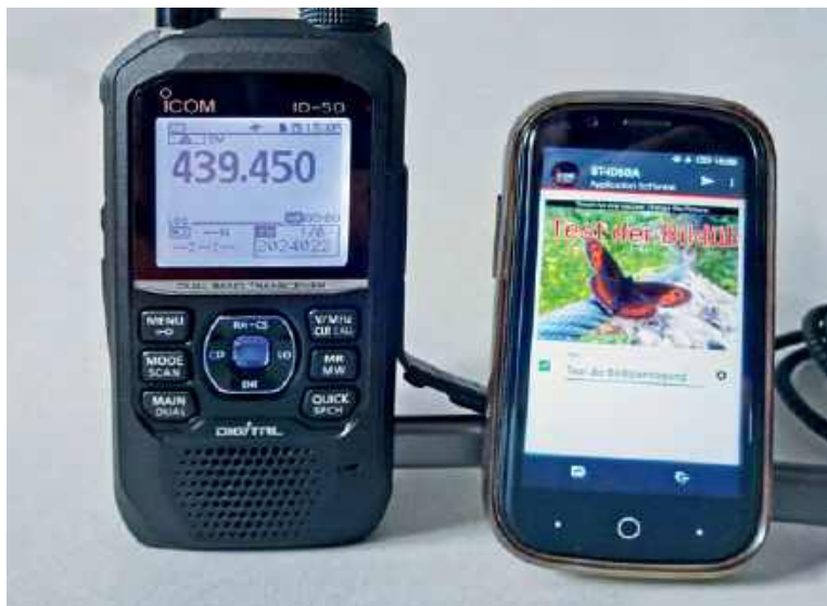
Ręczny radiotelefon i telefon połączone kablem USB-C w celu transmisji obrazu
