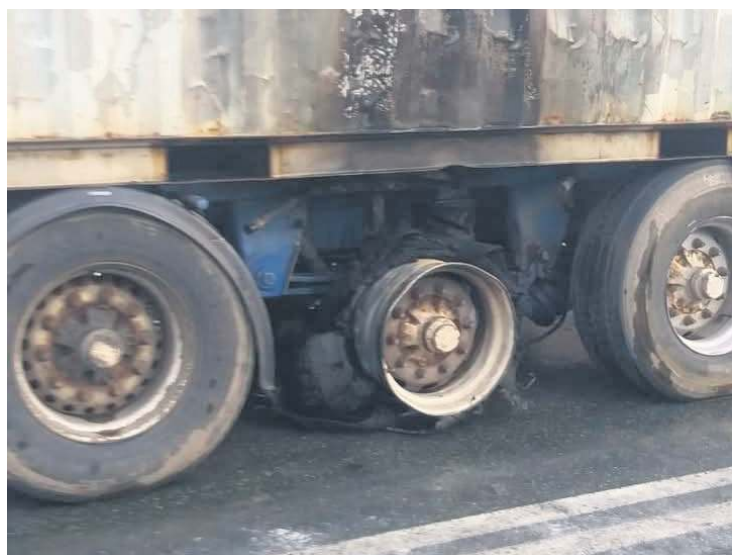
Zniszczeniu uległa jedna z opon naczepy. Fot. OSP Gostycyn
