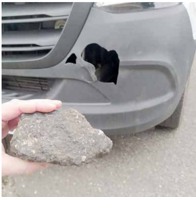
Kilkunastocentymetrowy kawałek asfaltu oderwał się od jezdni i uderzył w zderzak powodując zniszczenie
