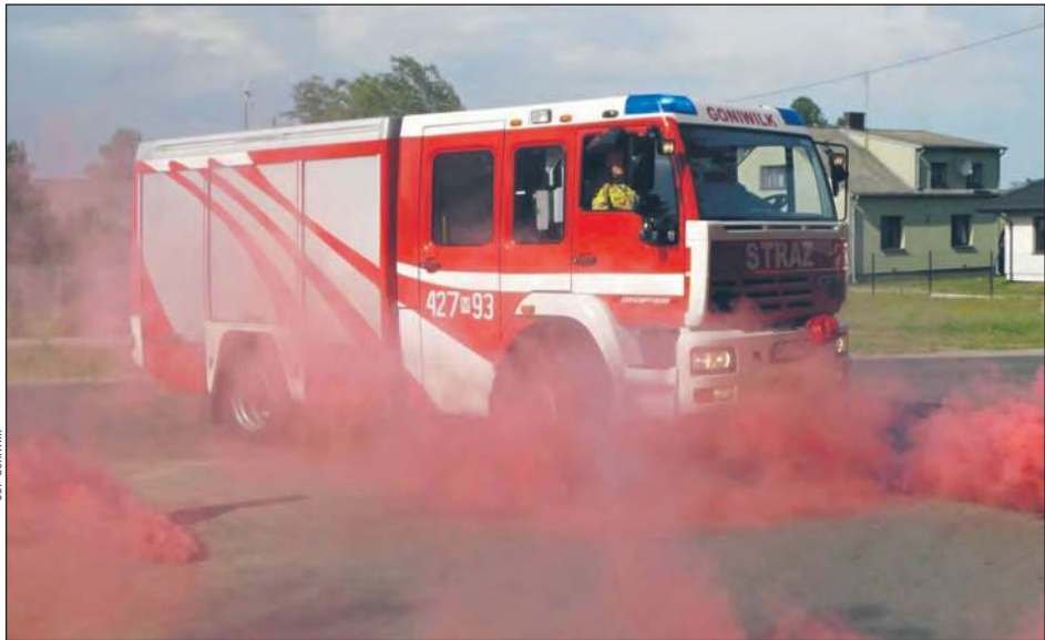
Samochód Steyr to średni wóz ratowniczo - gaśniczy z 2001 roku o oznaczeniu GBA 2.8/16. Zastąpił on wysłużonego już Jelcza z 1982 roku, który służył jednostce od 1996 roku
