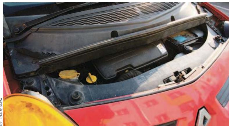
W wielu modelach silnik jest na tyle ciasno zabudowany, że ciężko dostać się do układu rozrządu
