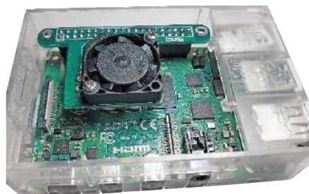
Fotografia 1. Zamontowany wentylator na Raspberry Pi 4B
