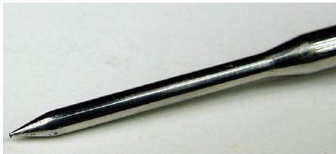
Fotografia 2. Grot sondy termometru DT12 z termoparą typu T
