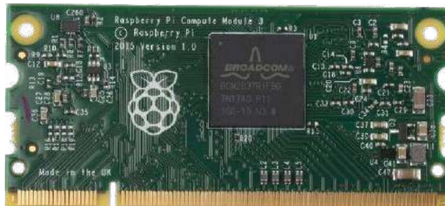
Fotografia 2. Raspberry Pi Compute Module CM3 (z materiałów www.raspberrypi.org )
