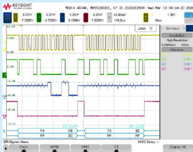
Rysunek 11. Odczyt i zapis rejestru Ctrl_meas (komenda wystartowania pomiaru)
