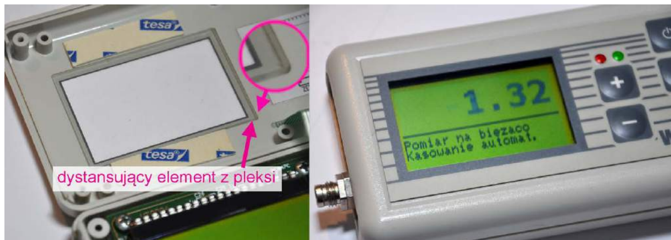
Fotografia 7. Płytkę dystansującą z pleksi nad wyświetlaczem na klawiaturze foliowej
