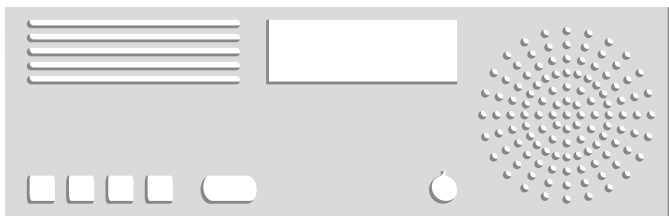
Rysunek 4. Przykład obudowy metalowej z „trudnymi” otworami
