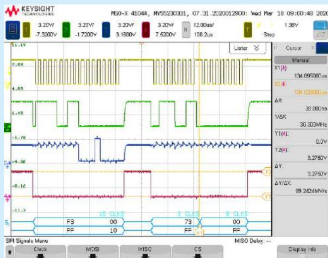
Rysunek 13. Zwiększenie częstotliwości zegara szyny SPI do 400 kHz
