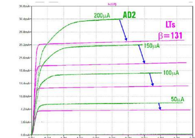
Rysunek 14. Porównanie zmierzonej i symulowanej charakterystyk I_C=f(U_{CE}) tranzystora 2N3904 z \beta=135
