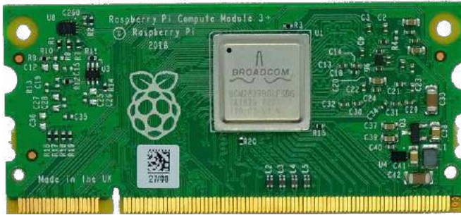
Fotografia 3. Raspberry Pi Compute Module CM3+ (z materiałów www.raspberrypi.org)
