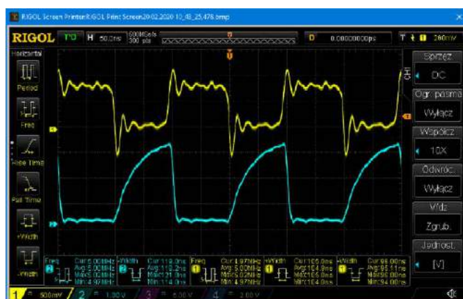
Rysunek 6. Pomiary oscyloskopowe dla częstotliwości 5 MHz
