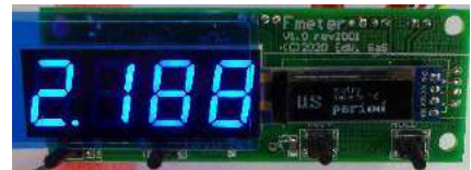
Fotografia 2. Ekran pomiaru czasu okresu sygnału
