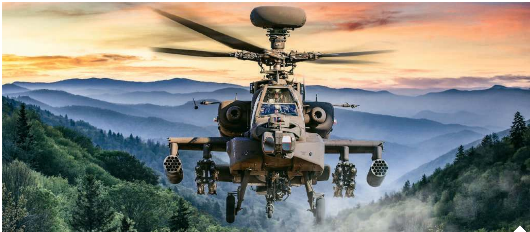
AH-64E Apache Guardian jest najnowszą wersją śmigłowca bojowego Apache, która została wyposażona w potężniejszy silnik T700-GE-701D o mocy 2000 KM oraz nowe kompozytowe łopaty śmigieł, co przekłada się na prędkość wznoszenia oraz zwiększoną manewrowość. | fot. Wikipedia/d
