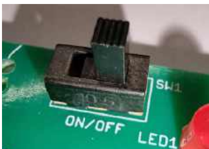
Fotografia 11. Montaż przetłacznika umożliwiającego galwaniczne odłączenie baterii od układu elektronicznego
