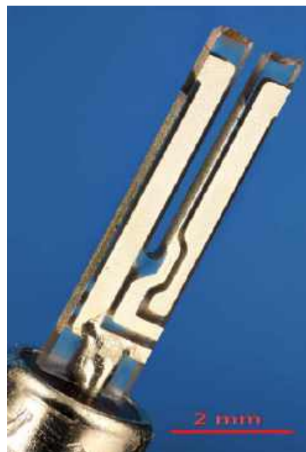
Fotografia 1. Rezonator kwarcowy 32,768 kHz w środku. Płytkę kwarcu wyciętą jest w formie kamertonu. Napylone na powierzchnię metalowe elektrody nie tylko pozwalają na jego zasilanie, ale też wpływają na częstotliwość drgań
