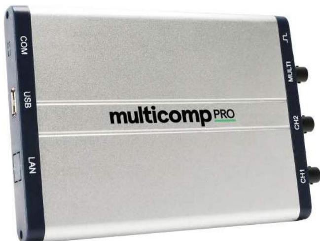
Fotografia 12. Oscyloskop USB marki Multicomp (opis w tekście)
