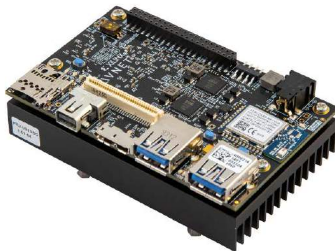
Fotografia 3. Płyta Ultra96-V2 wyposażona w układ Xilinx Zynq UltraScale+ oferuje inżynierom bardzo konkurencyjną cenowo platformę rozwojową do szybkiego prototypowania m.in. w zakresie sztucznej inteligencji
