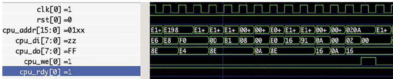
Rysunek 2. Przykładowe sygnały na magistrali podczas wykonania programu z pamięci synchronicznej
