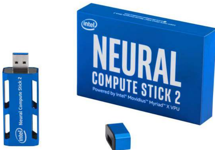
Fotografia 5. Zintegrowany akcelerator sztucznej inteligencji Intel Neural Compute Stick 2
