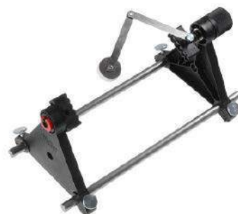
Fotografia 11. Uchwyt do płytek PCB typu WEL.ESF120ESD
