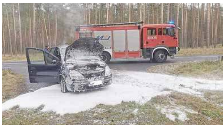
Auto dogasili strażacy, jak widać do zapłonu doszło pod maską, być może doszło do zwarcia instalacji elektrycznej Fot. PSP Goleniów
