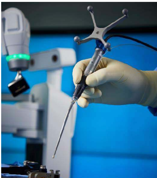
Fotografia 20. Zastosowanie systemu pozycjonowania wizyjnego Mazor do pracy z narzędziem ręcznym ( https://t.ly/ULA6v )
