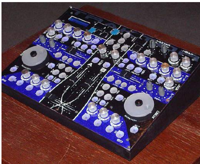
Fotografia 5. Kontroler programu Traktor na bazie MIDIBox64E wykonany przez Pay.C
