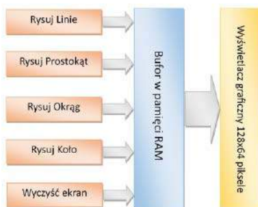
Rysunek 10. Koncepcja działania interfejsu graficznego obsługującego wyświetlacz LCD
