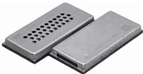
Fotografia 2. Głośnik xMEMS typu Montara Plus ( https://tinyurl.com/4hmy94u6 )
