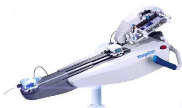
Fotografia 24. Robot Magellan marki Hansen Medical, przeznaczony do wspomagania zabiegów kardiologii inwazyjnej i angiologii ( https://t.ly/XC1nX )
