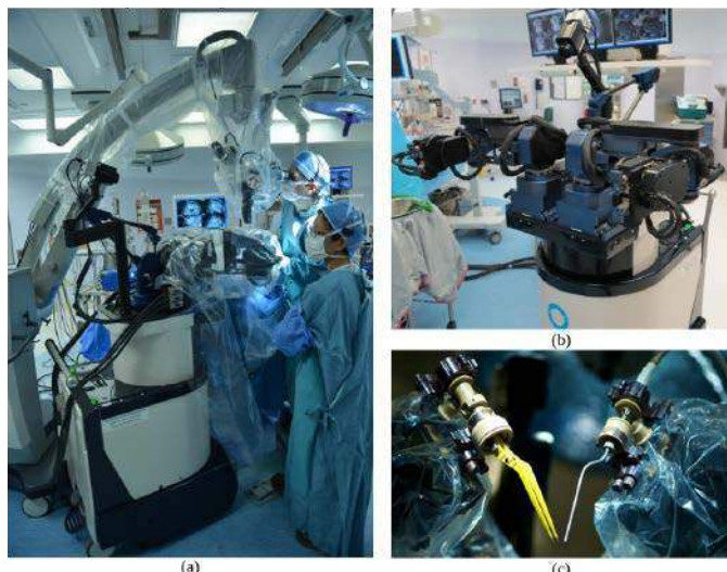
Fotografia 22. Robot neurochirurgiczny neuroArm: (a) – ramię robota czasie operacji, (b) – manipulatory robota (przed uzbrojeniem w narzędzia), (c) – końcówki robocze umieszczone na ramionach robota: po lewej – szczypce do koagulacji bipolarnej, po prawej – ssak ( https://t.ly/1gn6G )
