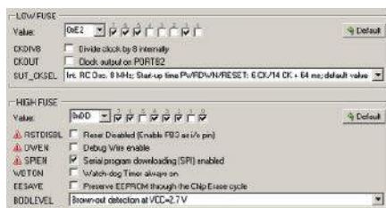
Rysunek 4. Szczegóły ustawienia bitów zabezpieczających
