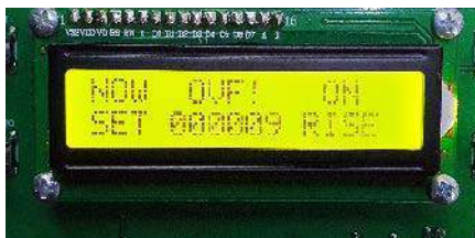
Fotografia 3. Sygnalizacja przepełnienia licznika
