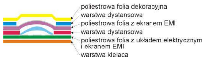
Rysunek 4. Przekrój klawiatury z ekranem EMI/RFI
