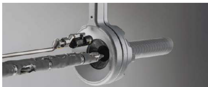
Fotografia 7. Narzędzia robota chirurgicznego marki Vicarious Surgical w stanie umożliwiającym wsunięcie ich do portu laparoskopowego ( https://t.ly/uMISW )
