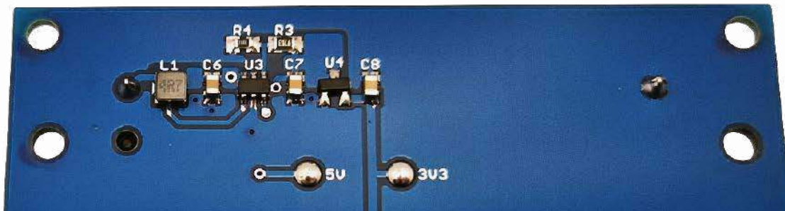
Fotografia 2. Zmontowane urządzenie e-Nurse od strony warstwy BOTTOM
