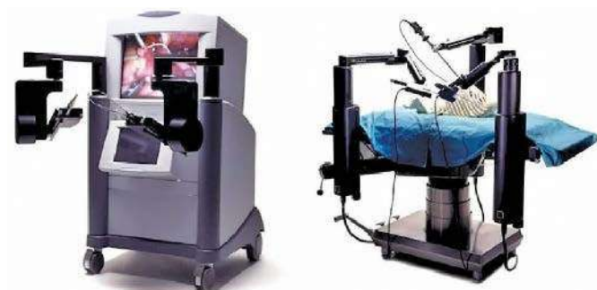
Fotografia 14. System ZEUS – jeden z pierwszych robotów chirurgicznych, które weszły do praktyki klinicznej ( https://t.ly/QwfkI )
