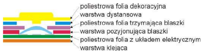
Rysunek 5. Przekrój klawiatury z przyciskami silikonowymi
