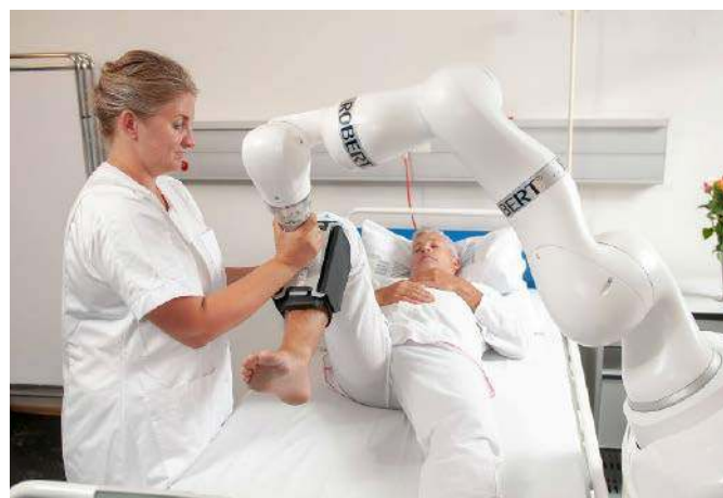
Fotografia 29. Ramię robota KUKA LBR Med, zastosowane do prowadzenia rehabilitacji ( https://t.ly/7fxLS )
