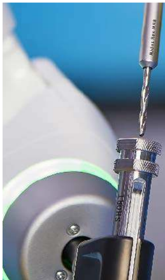
Fotografia 19. Wiertarka kostna, wprowadzana do tulei prowadzącej robota Mazor ( https://t.ly/8t910 )
