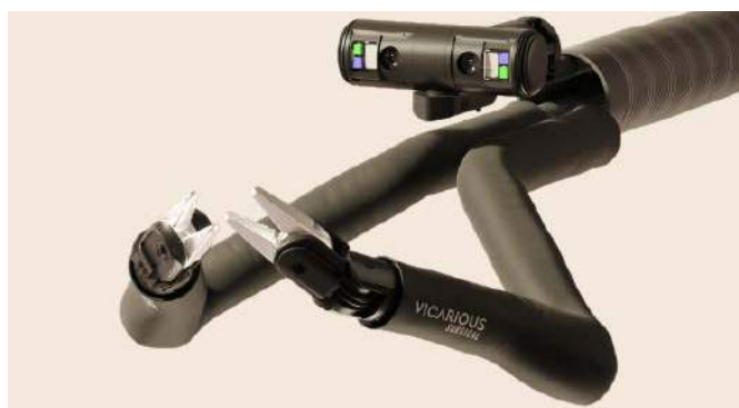
Fotografia 8. Narzędzia robota chirurgicznego marki Vicarious Surgical w stanie gotowości do wykonywania zabiegu ( https://t.ly/2N5-W )
