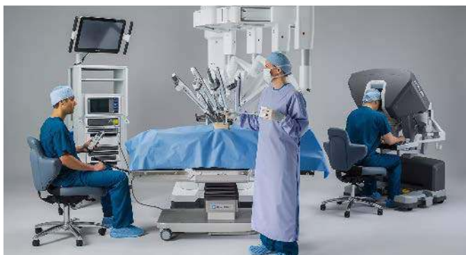
Fotografia 2. Podstawowy zestaw do chirurgii robotowej, od lewej: wózek z komputerem sterującym i systemem wizyjnym; wózek z ramionami robota; konsola sterująca ( https://t.ly/cyb6M )
