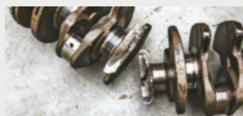
Pęknięcie wału korbowego może być związane z niskim poziomem oleju.
