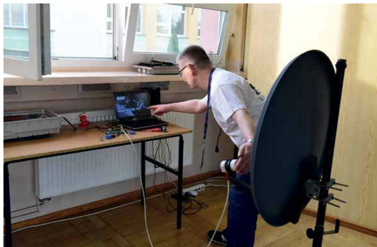
Stanowisko do odbioru sygnału DVB-S z QO-100. Armand SP3QFE przystąpił ręką oświetlacz, aby pokazać, że obraz odbierany jest na żywo z satelity
