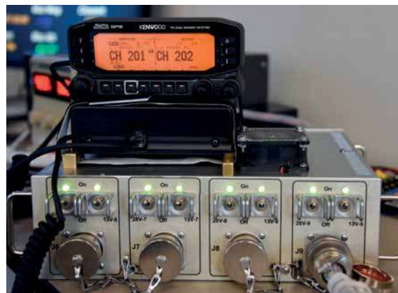
IORS składa się z radiostacji JVKenwood D710GA i zasilacza wielonapięciowego (MVPS). Radiostacja wyświetla tylko kanały, a nie częstotliwości, jak to ma miejsce w krótkofalarskich urządzeniach radiowych JVKenwood TM-D710GA
