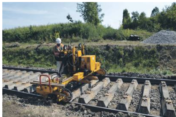
Nowoczesne urządzenia badają rozstaw torów
