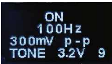
Zrzut ekranu 20. Generator przebiegów przydaje się do zastosowań audio (podobnie jak tryb oscyloskopu) lub jako prosty generator zegara. Generator może wytwarzać falę prostokątną o jednej z pięciu częstotliwości i jednej z czterech amplitud
