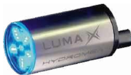
Rysunek 29. Podwodny modem optyczny Luma. Źródło: https://files.hydromea.com/luma/Hydromea_LUMA_X_datasheet.pdf
