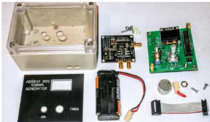
Zdjęcie przedstawia prawie wszystkie elementy generatora sygnału, z wyjątkiem elementów zmienionych w module DDS
