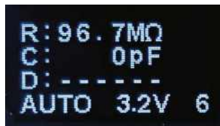
Zrzut ekranu 21. AUTO to tylko jeden z dziesięciu trybów, ale on jeden udowadnia wyższość opisywanej pęsety nad jej poprzednimi wersjami. Na stronie pokazywana jest rezystancja, pojemność oraz polaryzacja i napięcie przewodzenia diody
