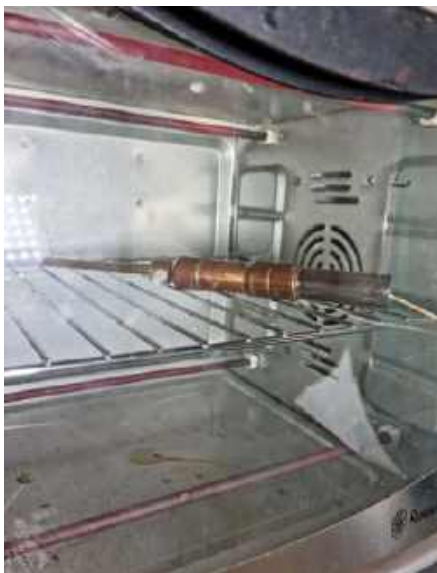
Reflow w obudowie można wykonać za pomocą dowolnego zwykłego piekarnika, rozgrzanego do temperatury 230°C. Nie należy jednak używać piekarnika, w którym gotuje się jedzenie. Efekt końcowy pokazano na zdjęciu po prawej stronie
