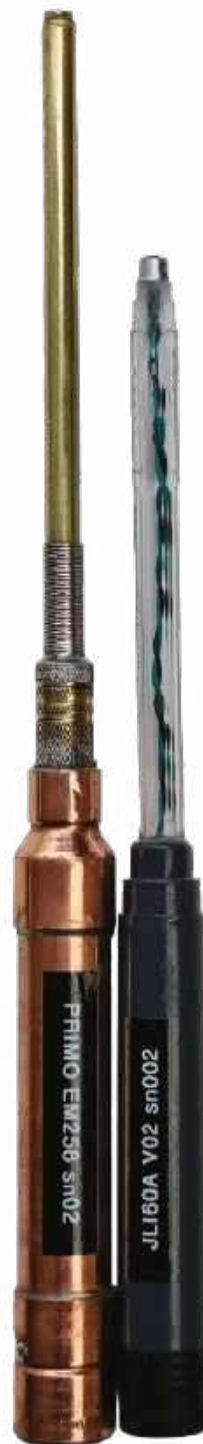
Zmontowane skalibrowane mikrofony pomiarowe w obudowach miedzianych i plastikowych
