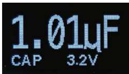
Zrzut ekranu 23. Tryb pomiaru pojemności działa podobnie, wyświetlając wyłącznie pojemność, za to w dużym rozmiarze. Jest idealny do sprawdzenia który element jest który w sterce kondensatorów SMD pozbawionych oznaczeń
