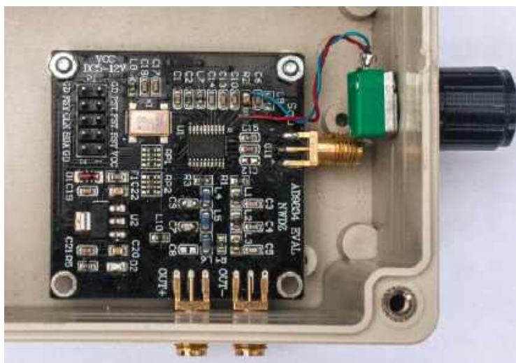
W module AD9834, w celu zwiększenia częstotliwości odcięcia filtru do 35 MHz, zostały wymienione cewki L4...L6 i kondensatory C7...C9. Poziomy wyjściowy generator jest regulowany dzięki wymianie rezystora R2 na potencjometr
