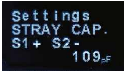
Zrzut ekranu 6. Pojemność rozproszoną można znaleźć automatycznie lub wprowadzić ręcznie. Powinna ona wynosić około 100 pF. Można to sprawdzić, ustawiając wartość rozproszoną na 0 pF i obserwując wynik w trybie pomiaru pojemności
