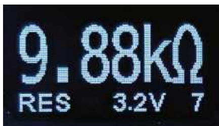
Zrzut ekranu 22. W trybie pomiaru rezystancji otrzymujemy te same wyniki, co w trybie Auto, ale pisane większą czcionką, co bardzo ułatwia sprawdzanie i sortowanie rezystorów
