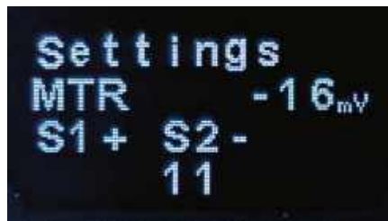
Zrzut ekranu 7. Przesunięcie („offset”) miernika można dostosować do dowolnej różnicy napięć między dwoma dzielnikami 1 kΩ/1 kΩ. Przesunięcie jest ustawiane na stronie AUTO SET. Błąd 16 mV odpowiada rozrutowi pomiaru ADC; tyle wynosi pojedynczy krok przetwornika
