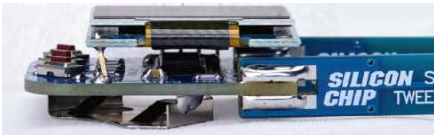
W poprzednim odcinku wspominaliśmy, że pin ze złącza „goldpin” w jednym rogu wyświetlacza służy jako element wzmacniający. Zapobiega to wyginaniu się wyświetlacza i zwarciom między obiema płytkami
