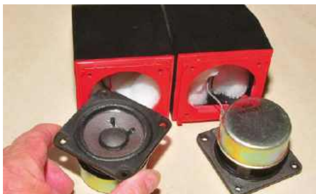
Rysunek 8. Wnętrze szczelnej, plastikowej obudowy wypełnionej watoliną umieszczony jest dwucalowy głośnik. Nie ma głośnika wysokotonowego!
