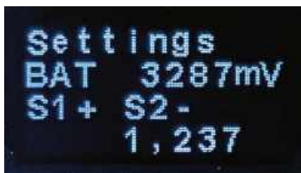
Zrzut ekranu 3. Pomiary diod i kondensatorów będą najdokładniejsze, jeśli zostanie skalibrowane wewnętrzne napięcie odniesienia. Nastawiamy je przyciskami S1 i S2, aż wyświetlane napięcie baterii będzie zgodne z rzeczywistym
