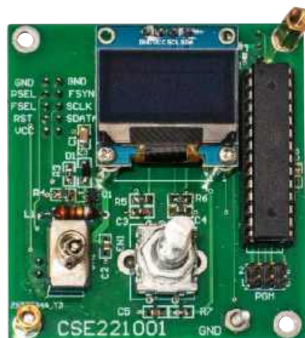
Rysunek 5. Elementy na płytce sterownika montujemy według rysunku. Zwróćcie uwagę, że pod wyświetlaczem OLED znajdują się dwa rezystory 4,7 k \Omega , a jeden kondensator 100 nF jest na spodzie płytki drukowanej
