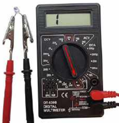
Fotografia 10. Sprawdzanie diody LED za pomocą multimetru ustawionego na funkcję testowania diod. Po przyłożeniu sondy czerwonej do anody, a czarnej do katody, sprawna dioda LED powinna się zaświecić. Jeśli dioda ma odpowiednie długie (jeszcze nie przycięte) wyprowadzenia można się wspomóc krokodylkami
