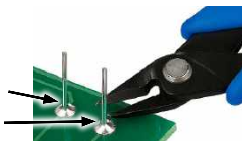
Rysunek 5. Właściwe miejsce cięcia nadmiaru wyprowadzeń po przylutowaniu komponentu. Po wykonaniu cięcia spoina powinna pozostać nienaruszona
