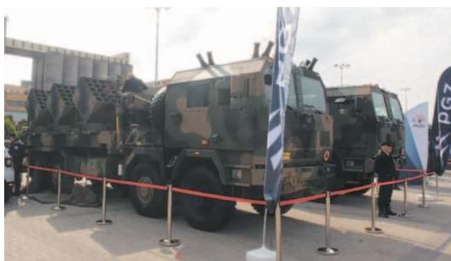
Mierzący 11 metrów długości Pojazd Minowania Narzutowego Baobab-K był, dosłownie, największym premierowym wyrobem HSW na MSPO 2021. Prezentowana wersja to zamontowana na podwoziu Jelcz 8x8 platforma z sześcioma miotaczami min MN-123 mieszczącymi łącznie 600 pocisków
