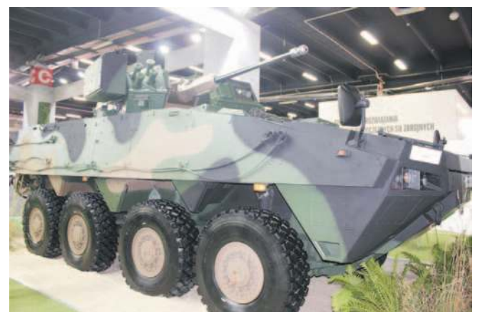
Po raz kolejny HSW pokazała bezzałogowy Zdalnie Sterowany System Wieżowy ZSSW-30, tym razem na Kołowym Transporterze Opancerzonym Rosomak. Zgodnie z niedawno aneksowaną umową, w pierwszym rzucie Huta dostarczy wojsku 341 takich systemów
