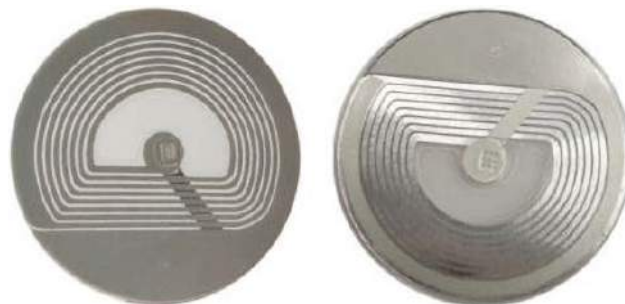
Fotografia 3. Naklejka antykradzieżowa RFID pracująca w paśmie 8,2 MHz ( https://t.ly/_ShWY )
