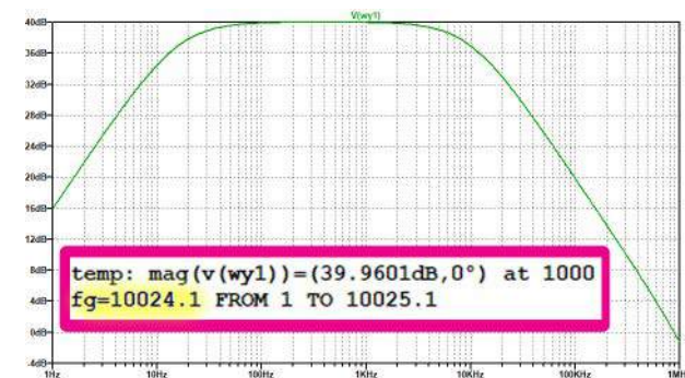
Rysunek 6. Symulowana charakterystyka częstotliwościowa wzmacniacza LM324
