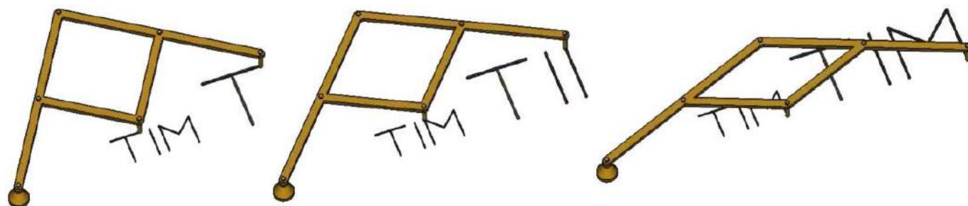
Rysunek 1. Schematyczny rysunek budowy pantografu, pokazujący jego zasadę działania
