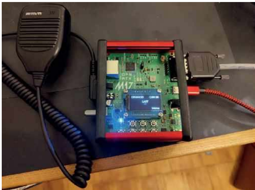
Module17 – prototyp najnowszej wersji 1.0 w estetycznej, aluminiowej obudowie Hammond
