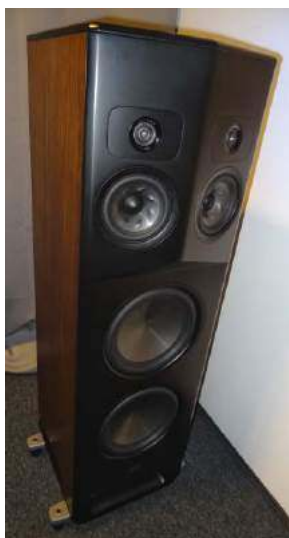
Również nowiutka i tym razem zaskakująca kolumna Polk Audio – L800 – nawiązuje do modelu SDA-SRS z 1985 roku. Zdblowane sekcje średnio-wysokotonowe nie służą powiększeniu obszaru odsłuchu, ale „doprecyzowaniu” stereofonii za pomocą wprowadzenia odpowiednich relacji fazowych. Taki system jest cechą tylko tej największej konstrukcji serii, ale do obydwu modeli wolnostojących (również do L600) można dodać (położyć na górze) moduł „atmosowy” L900.
