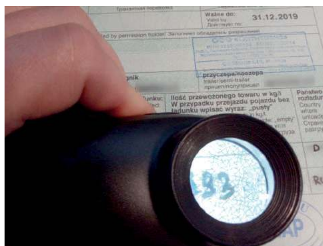
Urządzenie z użyciem promieni ultrafioletowych pozwoliło na wykrycie przeróbek w dokumencie
