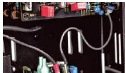
Sygnał audio z przedwzmacniacza jest niezbalansowany i przesyłany do końcówek mocy za pomocą przewodów.
