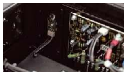
Nad bezpieczeństwem końcówek czuwa kilka obwodów, jeden z nich monitoruje temperaturę na radiatorach.
