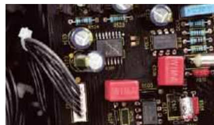
Regulator głośności to scalak Burr Browna z serii PGA.
