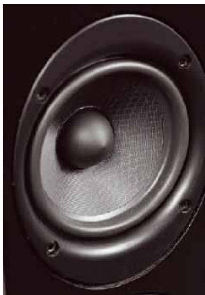
Nisko-średnietonowy i niskotonowy mają podobne membrany – z plecionki z włókna szklanego – ale różnią się co najmniej ich nakładkami przeciwpływowymi.
