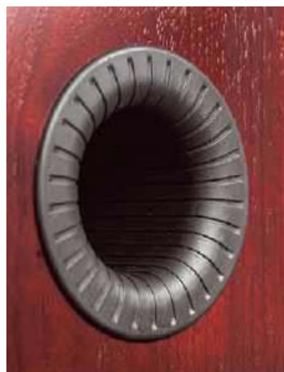
Wyprofilowanie HIVE w praktyce niewiele zmienia... Ale wiele może zmienić zastosowanie pierścieni i walców pozwalających regulować częstotliwość rezonansową układu bas-refleks.
