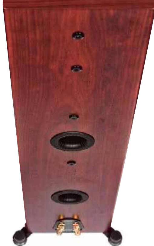
Tym razem na pierwszy rzut oka bez większego kombinowania – dwa okrągłe bas-refleksy wyprowadzono z tyłu, z jednej wspólnej komory obydwu niskotonowych.
