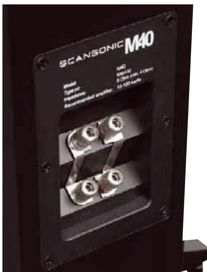
Terminal M40 to niemal standardowy, niskobudżetowy element, tylko z lekko powiększoną oprawką, prawdopodobnie po drugiej stronie znajduje się płytka zwrotnicy.
