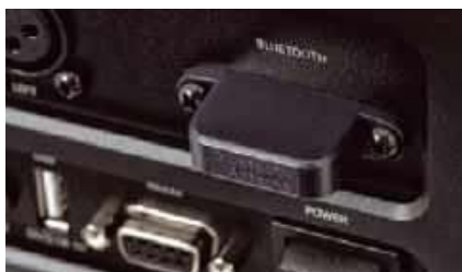
Jednym z nawiązań do sprzętu Rotela jest kapsułka z modulem Bluetooth.
