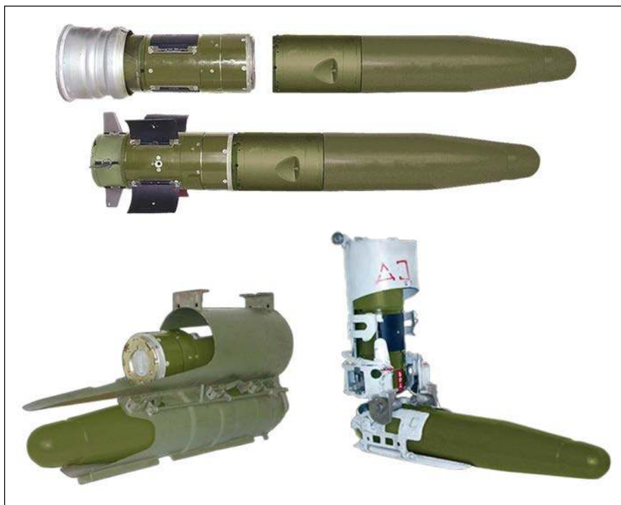
▲ Przeciwpancerny pocisk kierowany Kombat . U góry w konfiguracji ładowania do automatu (podzielony na dwie części, do tylnej dołączona łuska z ładunkiem miotającym), z kolei na dole – w konfiguracji lotnej; poniżej – pocisk kierowany Kombat w automacie ładowania amunicji czołgu T-72 (z lewej) oraz T-64/T-80UD lub T-84.
