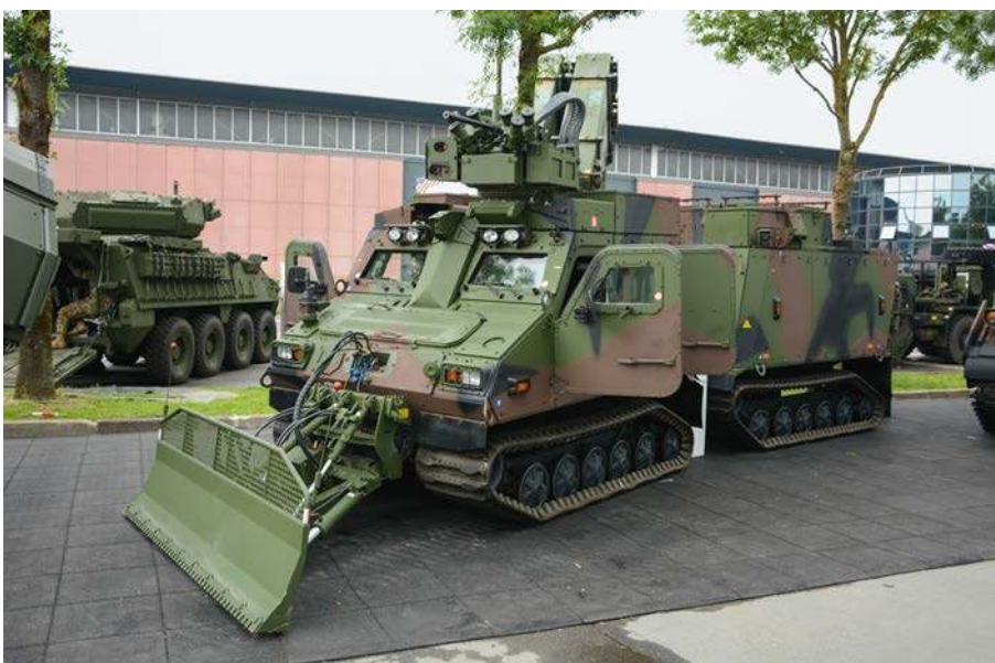
▲ BvS 10 z lemieszem i coraz powszechniejszym obecnie bezzałogowym stanowiskiem ogniowym prezentowany przez producenta na salonie Eurosatory 2018.
