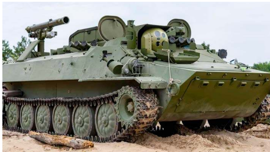
▲ Samobieżny zestaw przeciwpancerny Szturm-SM , a w jego przedniej części kadłuba widoczna zainstalowana optoelektroniczna stacja celownicza OPSN-I.
