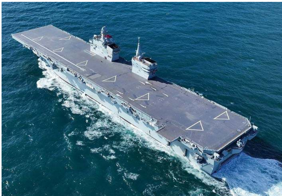
▲ Okręt desantowy-śmigłowcowiec Sycuan projektu 076, na którym widoczna jest katapulta (biała linia wzdłuż lewej krawędzi dziobowej części pokładu).
