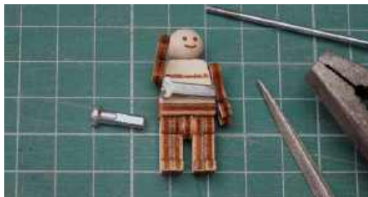
Pierwotnie do poruszania dźwigni mechanizmu startowego miał służyć nagwintowany odcinek szprychy oraz odpowiedni nypel z gwintem M2,5
