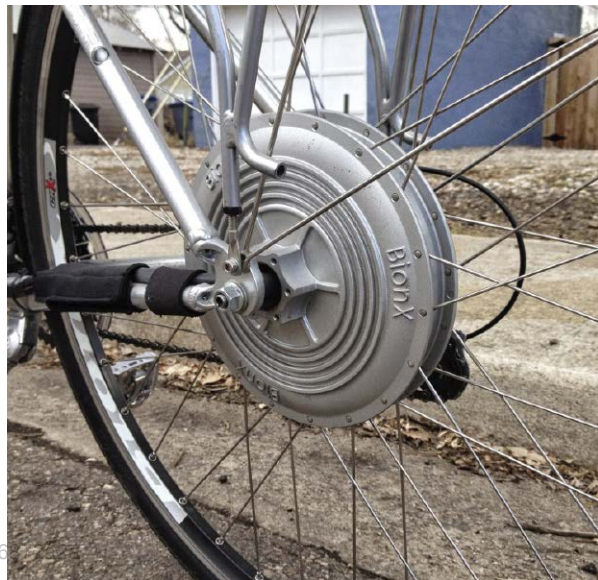
8. Moduł hamowania regeneracyjnego w rowerach BionX
