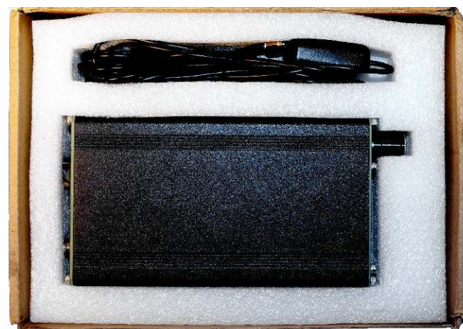
Fotografia 1. Generator w opakowaniu. Antena ma dość długi kabel i jest wyposażona w magnes, który pozwala umocować ją do zewnętrznego parapetu lub balustrady balkonu. Pierwotnie była częścią samochodowego zestawu nawigacyjnego
