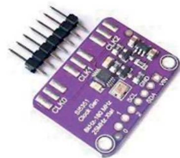
Moduł syntezy częstotliwości Si5351
