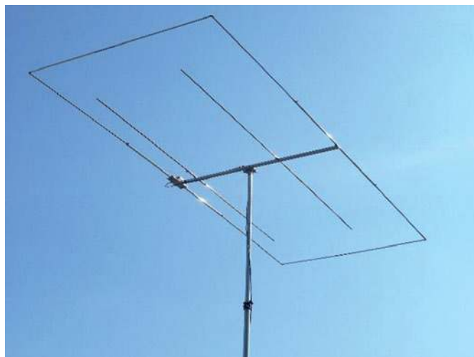
Antena dwupasmowa MOXON 6 m / 4 m
