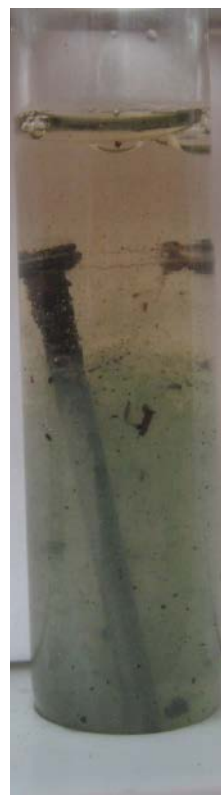
6. Zielonkawy osad wodorotlenku żelaza(II) świadczy o korozji stali w zakwaszonym roztworze (widok po zobojętnieniu kwasu roztworem wodorotlenku sodu)
