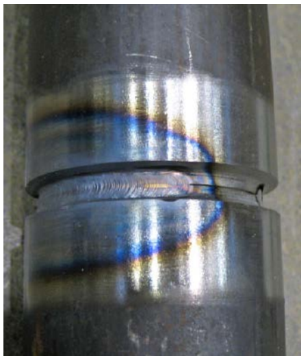
2. Korozja chemiczna wokół spawu spowodowana miejscowym nagrzaniem stali (źródło: Wikipedia, autor: Yannick Trottier)
