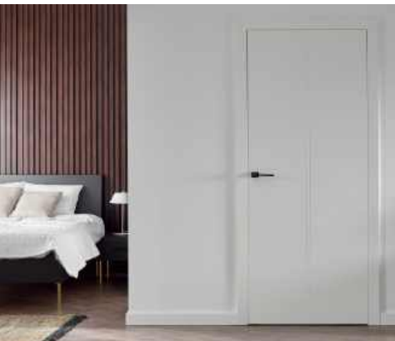
❶ Drzwi bezprzylgowe tworzą z ościeżnicą jednolitą, gładką powierzchnię – bez widocznego uskoku charakterystycznego dla modeli przylgowych. vox
