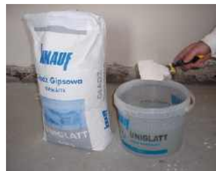
Gładź rozrabia się wodą w proporcjach podanych na opakowaniu.
