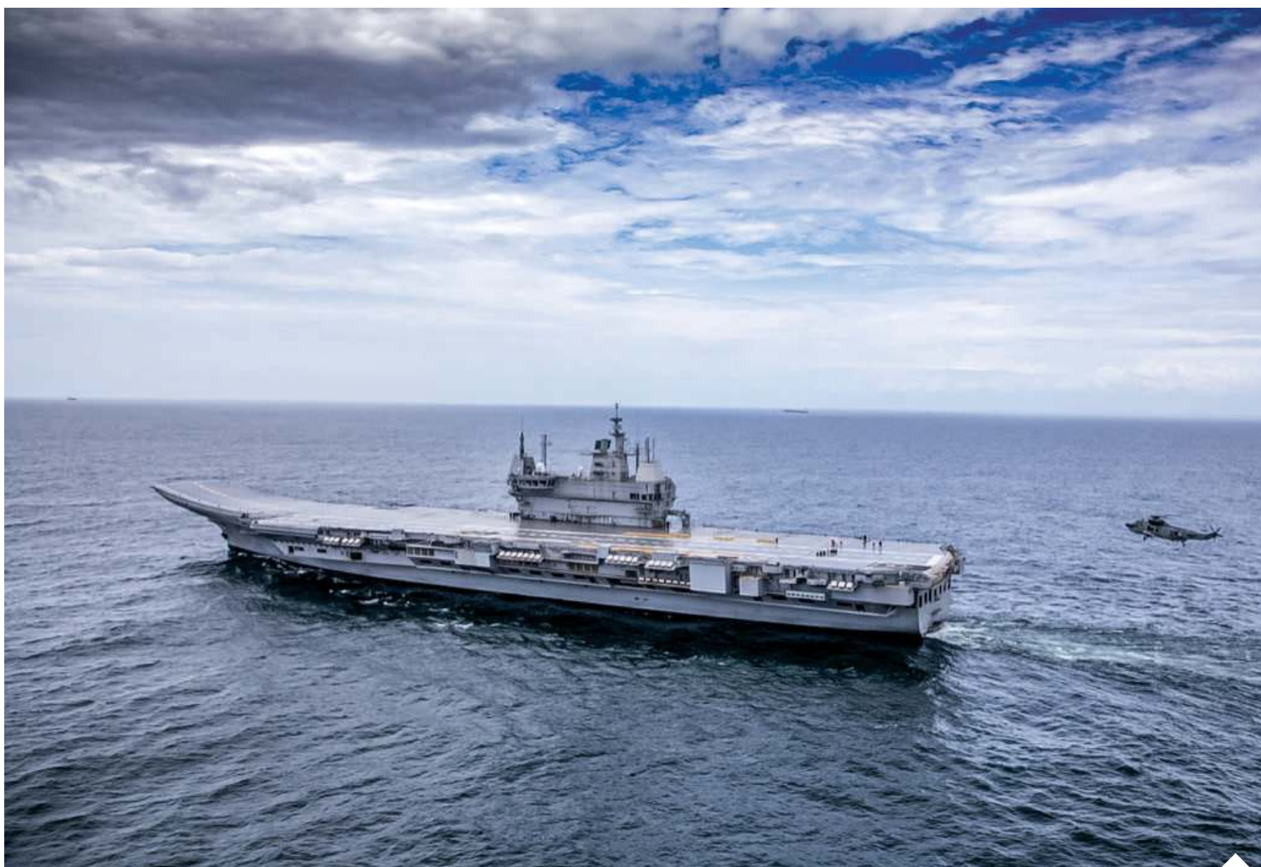
Lotniskowiec INS „Vikrant” ma wyporność 45 tys. ton, długość 262 m oraz szerokość 62 m | fot. Wikipedia/d
