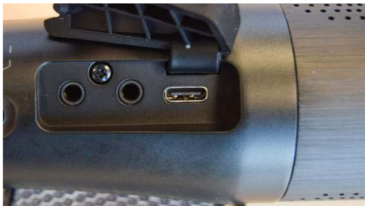
Pod przełącznikiem głośności znajduje się gumowa klapka, osłaniająca trzy gniazda.
