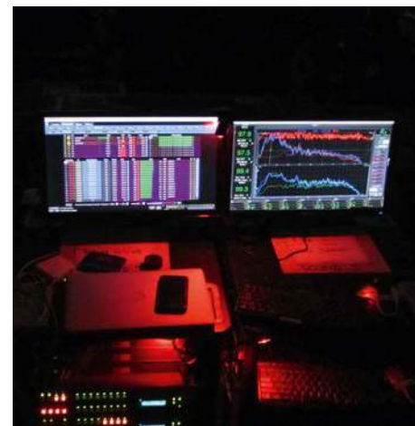
Dwukanałowe analizatory audio o wysokiej rozdzielczości są obecnie standardowym narzędziem w pracy każdego realizatora i inżyniera systemu.
