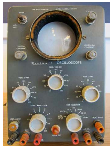
Sprzętem używanym standardowo w laboratoriach badawczych i na stanowiskach testowych był oscyloskop.
