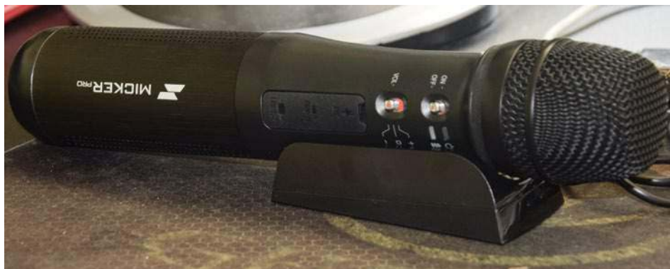
Ładowanie urządzenia może odbywać się poprzez gniazdo USB C lub stację dokującą.
