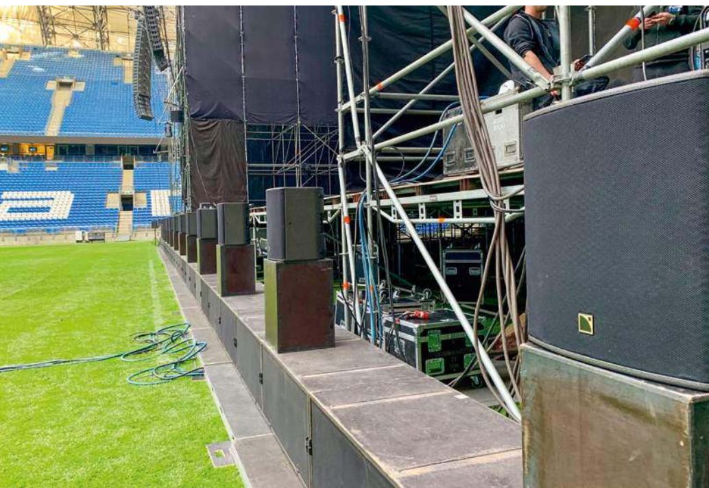
Uzupełnienie gron stanowiły 23 zespoły głośnikowe X12 (6 sztuk jako infill oraz 17 sztuk jako frontfill) i 32 sztuki subbasów SB28, ułożonych w jednej linii wzdłuż sceny.
