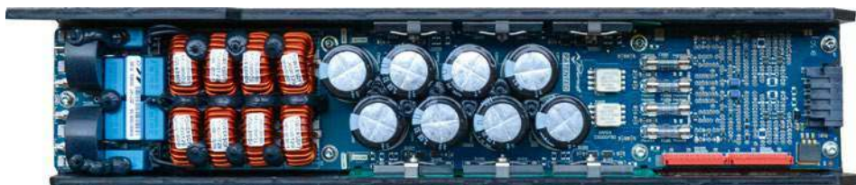
...z których każdy zawiera dwie końcówki mocy pracujące w mostku.
