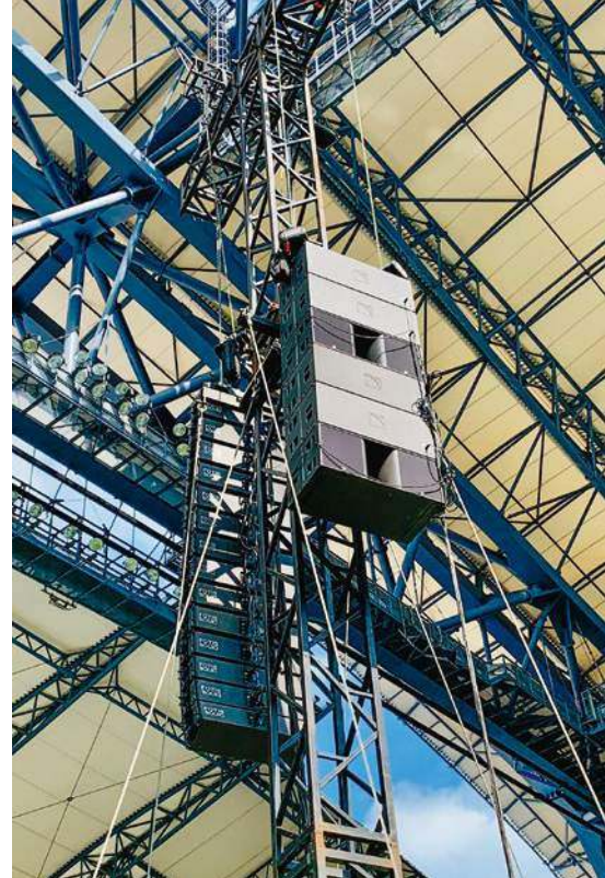
Na każdej z wież zainstalowano po 14 elementów K2, a za nimi po 6 subwooferów KS28 w kardioidzie.
