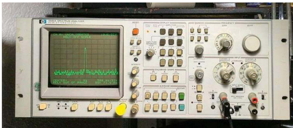
Jednym z bardziej znanych analizatorów, używanych w procesie produkcji i testowania gotowych wyrobów w branży pro audio, było urządzenie marki Hewlett Packard HP3582.
