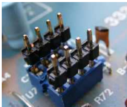
Rysunek 13. Wyprowadzenia adapterów najłatwiej jest lutować po umieszczeniu niezmontowanej jeszcze płytki w podstawce. Utrzymuje to piny w odpowiednim ustawieniu i zapewnia stabilną platformę podczas lutowania elementów adaptera i wzmacniaczy operacyjnych. Zwróć uwagę na układ 8087, który zastąpił TL072 w starym mikserze
