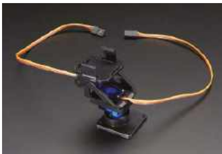
Rysunek 1. Mechanizm obrotu i pochylenia z wykorzystaniem dwóch mikroserwomechanizmów. Zdjęcie: Adafruit
