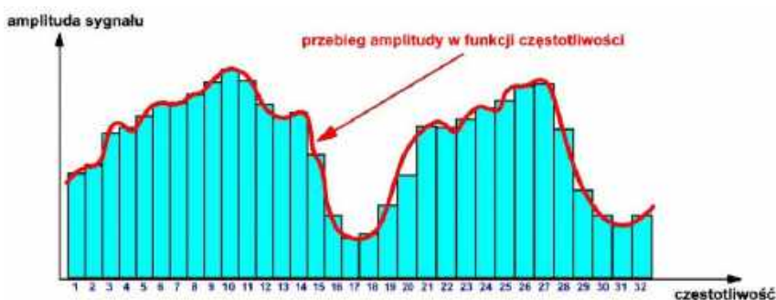
32 cyfrowe podpasma o szerokości 600 Hz (© 2020 Jos Verstraten)
