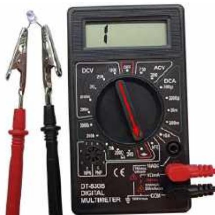
Fotografia 3. Sprawdzenie diody LED za pomocą multimetru ustawionego na funkcję testowania diod. Po przyłożeniu sondy czerwonej do anody, a czarnej do katody, sprawna dioda LED powinna się zaświecić. Jeśli dioda ma odpowiednio długie (jeszcze nie przycięte) wyprowadzenia można się wspomóc krokodylkami
