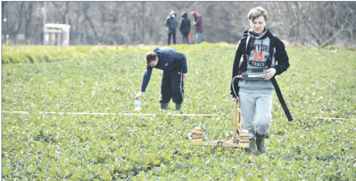
Badania nieinwazyjne prowadzono metodami magnetyczną i elektrooporową
