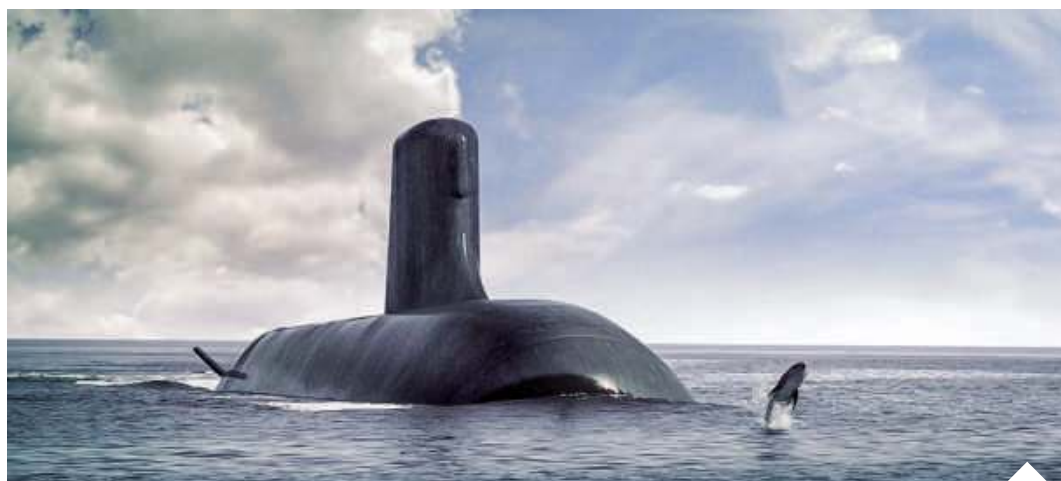
Okręty podwodne z napędem jądrowym typu Barracuda mają długość 99,5 m, szerokość 8,8 m i wyporność wynoszącą 5300 t | fot. mat. pras./d
