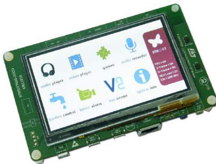
Fotografia 1. Płytkę STM32F746-Discovery z wbudowanym wyświetlaczem
