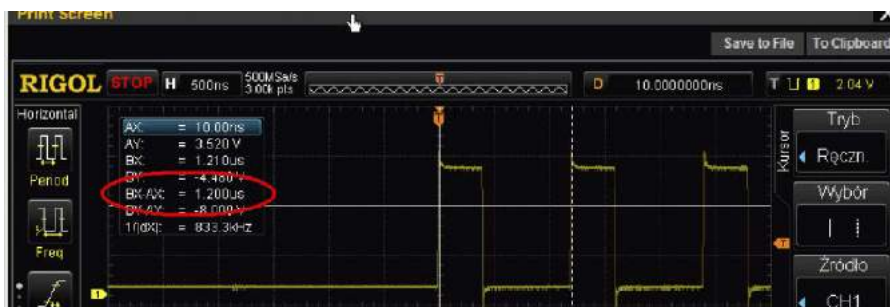
Rysunek 8. Zmierzona maksymalna przepływność interfejsu UART
