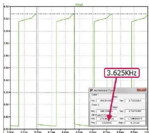
Rysunek 15. Przebieg wyjściowy symulowanego multiwibratora z elementami NAND i RC
