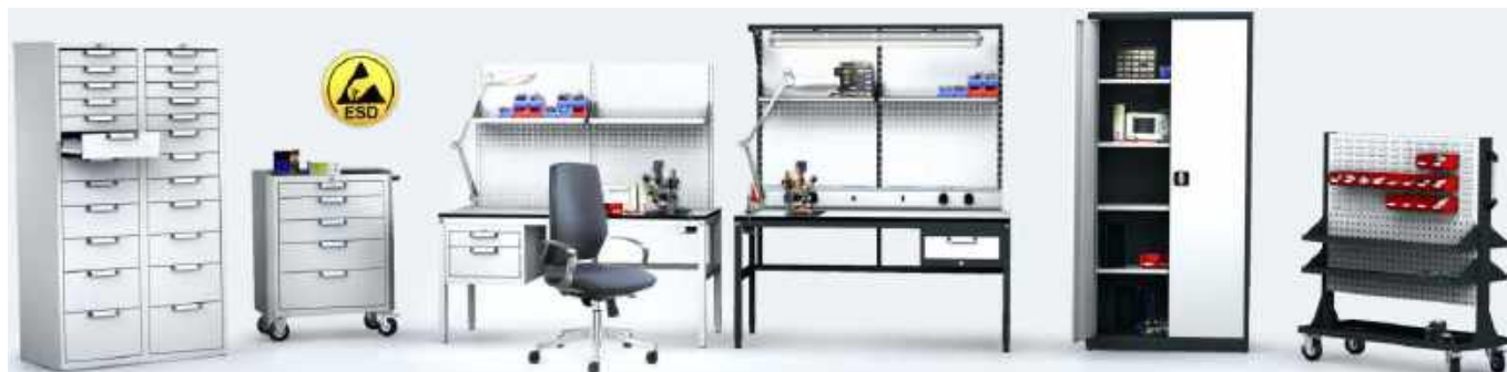
Fotografia 23. Przykładowe wyposażenie strefy EPA ( https://t.ly/AFvUV )
