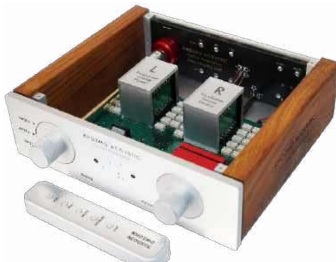
Fotografia 4. Układ regulacji głośności z transformatorem obsługiwany przez przełączniki [5]
