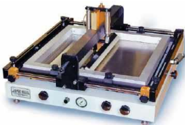
Fotografia 4. Półautomatyczna drukarka szablonoowa SPR-45 marki DDM Novastar ( https://t.ly/PS5mh )
