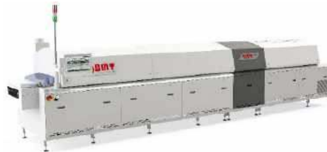
Fotografia 15. Piec rozpliwowy z modułem próżniowym marki SMT Wertheim (https://t.ly/WzLEd)
