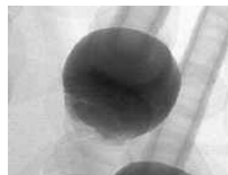
Fotografia 19. Obraz rentgenowski pokazujący uszkodzenie kulki spoiwa pod układem BGA. Widok zarejestrowany przy użyciu systemu MXI QUADRA 7 Pro ( https://t.ly/VH_-x )
