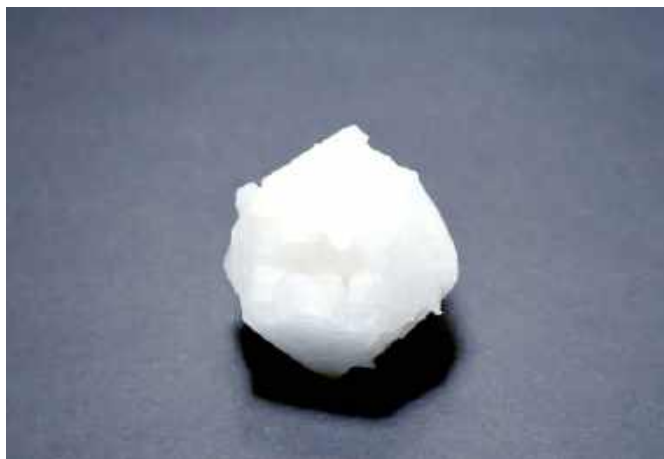
Fotografia 4. Udany model z nylonu PA12 – dwunastościan z zębatek
