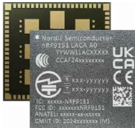
Fotografia 2. Moduł nRF9151 z potężnym, 64-megahercowym procesorem ARM Cortex-M33 przetwarza pomiary środowiskowe, takie jak temperatura, ciśnienie, przyspieszenie i wilgotność, a następnie przesyła je do chmury za pomocą modemu wielomodowego
