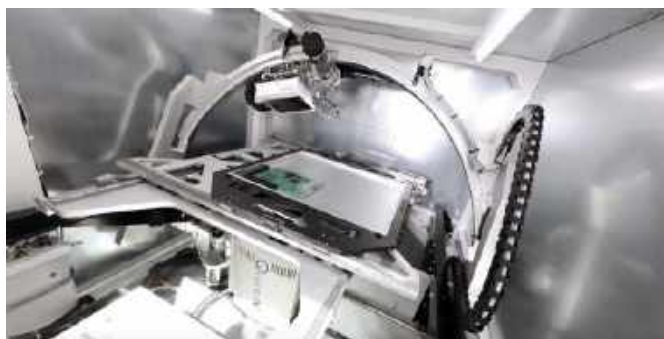
Fotografia 20. Wnętrze maszyny QUADRA 7 Pro marki Nordson ( https://t.ly/VThh7 )
