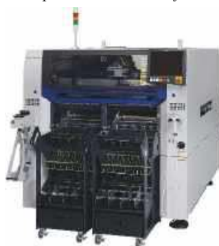
Fotografia 7. Ultrawydajny automat pick&place – YRM20DL marki Yamaha ( https://t.ly/KXsDF )
