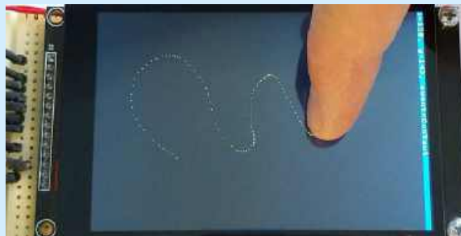
Fotografia 8. Efekt pracy testowego programu dla panelu dotykowego
