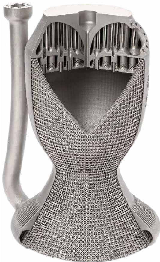
2. Prototypowa dysza rakietowa Cellcore z wewnętrznymi kanałami chłodzącymi – produkcja addytywna
