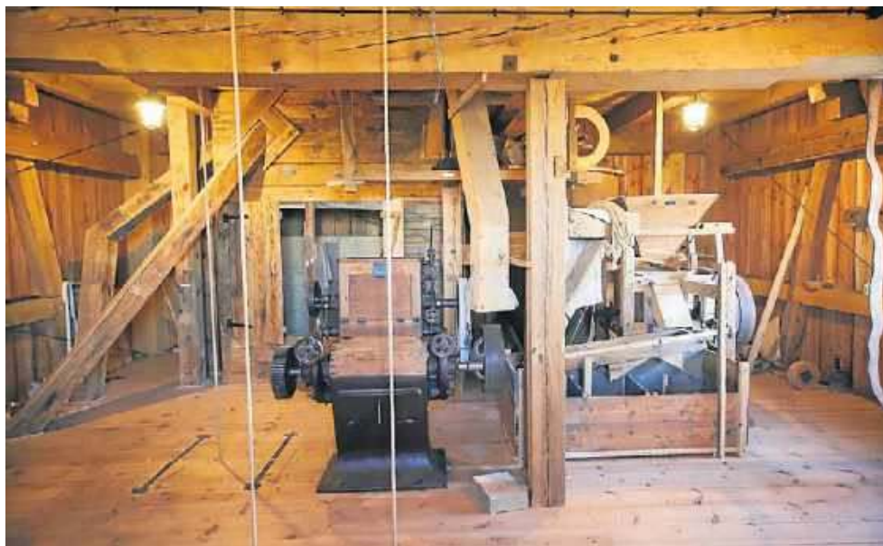
Zabytkowy mlewnik walcowy służący do rozdrabniania ziarna
