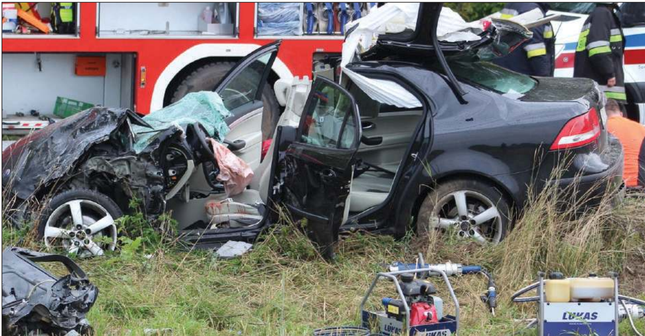
» Aby wyciągnąć ludzi z auta strażacy musieli użyć narzędzi hydraulicznych do rozcinania karoserii
