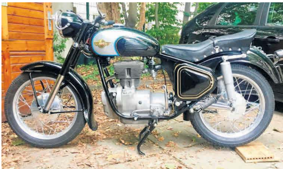
Simson 425 Sport nie był kopią żadnego z modeli BMW choć jego silnik wzorowano na jednostce napędowej R-25. W oznaczeniu 425 zaszyfrowano: 4 suwy, 250 centymetrów sześciennych pojemności
